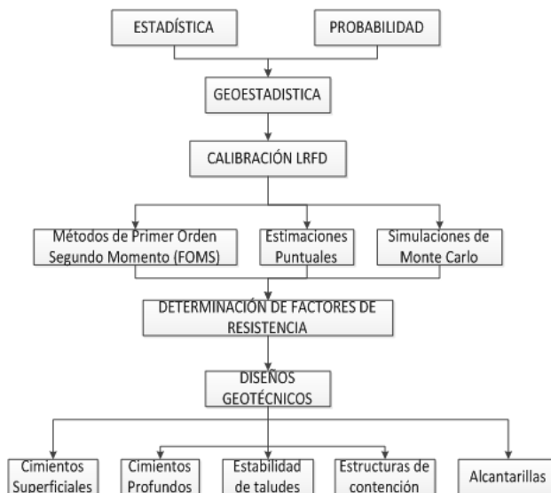
Figura 4 Secuencia típica en el desarrollo de un diseño geotécnico aplicando LRFD
