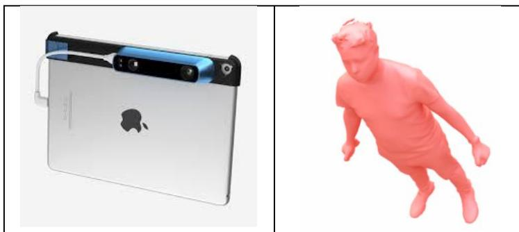
**Imagen 26. Structure Sensor adaptado a la Tablet y objeto obtenido del escaneado**
