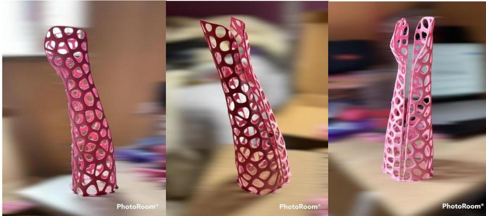
**Imagen 38. Órtesis finalizada impresa en impresora 3D FMD**
