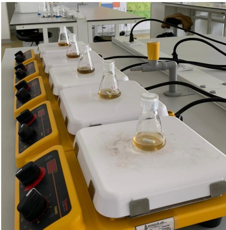
Figura 3.4: Soluciones de etanol con distintas concentraciones de curcumina y 10mg de CDs en cada una de ellas
