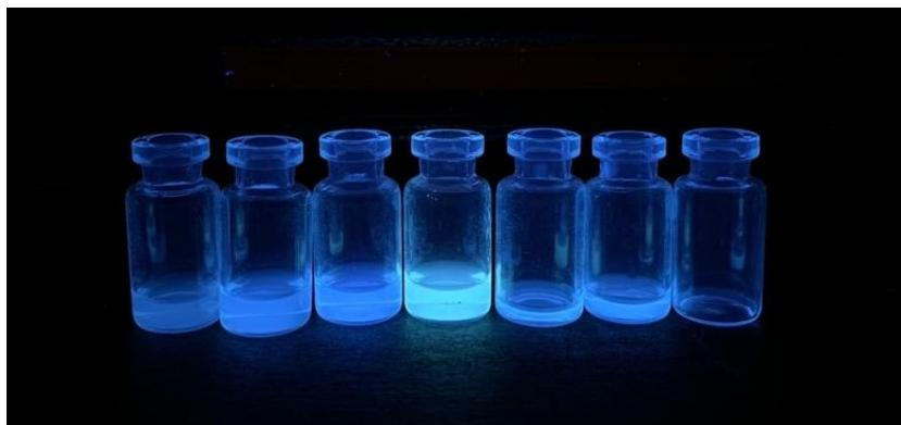
Figura 4.5: Puntos de carbono funcionalizados bajo luz ultravioleta
