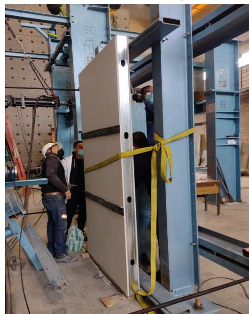
Fotografía 4 Posicionamiento del ensayo a flexión
