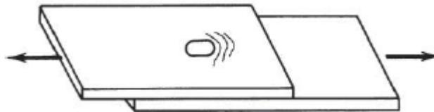
Figura 7 Falla por acumulación del material. Fuente (USG Corporation, 2014)
