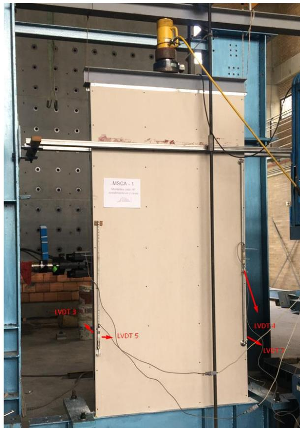
Fotografía 14 Instrumentación ensayos a compresión
