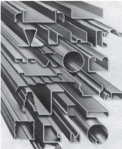
Figura 3 Secciones formadas en frío Fuente: (Yu, 2003)
