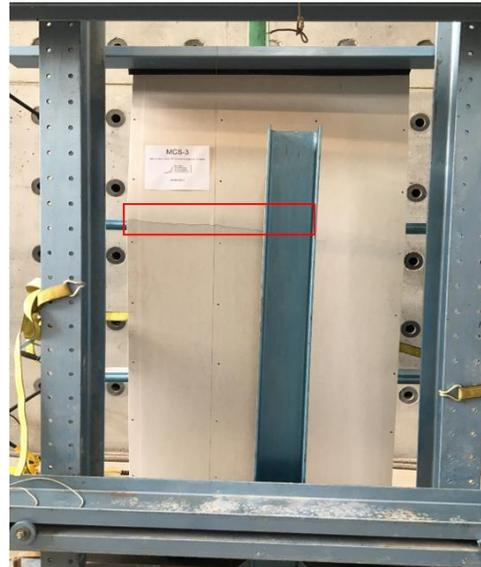
(d) *Fractura del revestimiento en la cara sometida a tensión*
