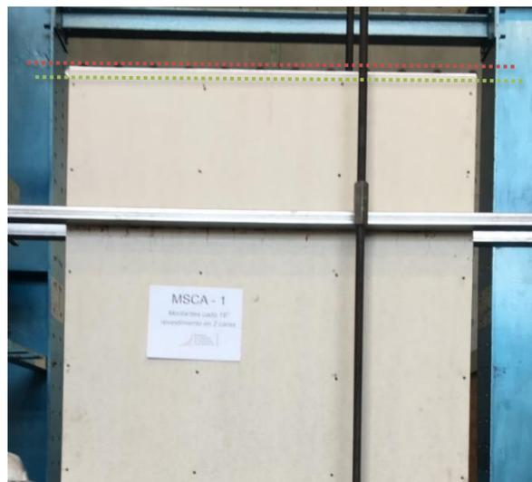
Fotografía 15 diferencias de altura panel - revestimiento
