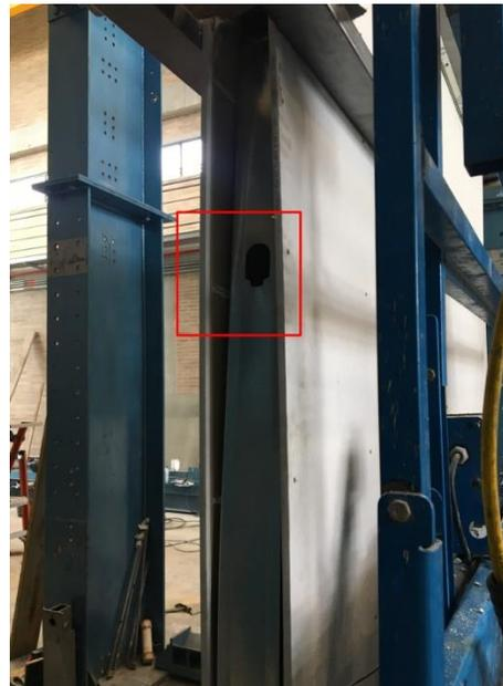
(c) fractura del revestimiento- separación del marco metálico -revestimiento
