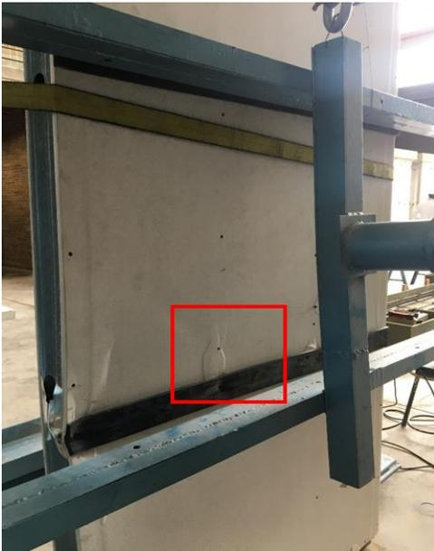
(a) Fractura del revestimiento en la conexión al montante.
