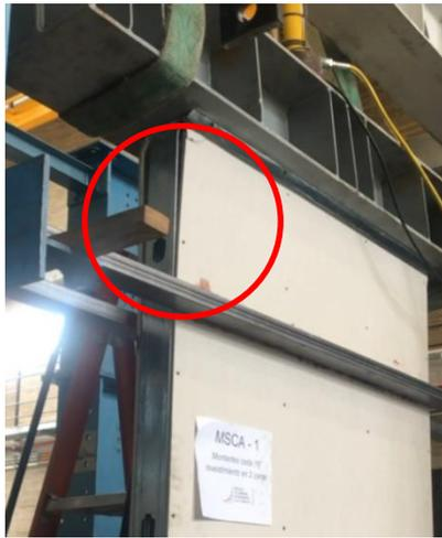
(a) falla de la conexión revestimiento – montante.
