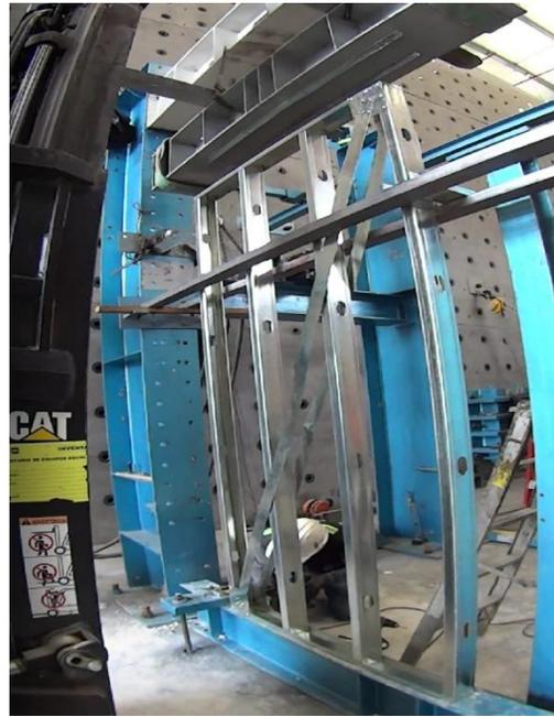
Fotografía 10 fijación de todos los perfiles.
