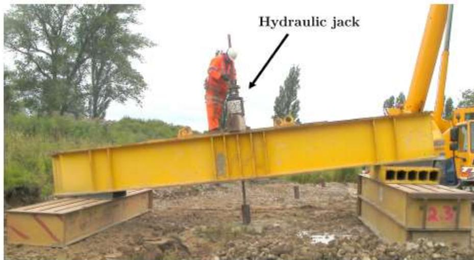
**Figura 3-14. Sistema de carga.**
