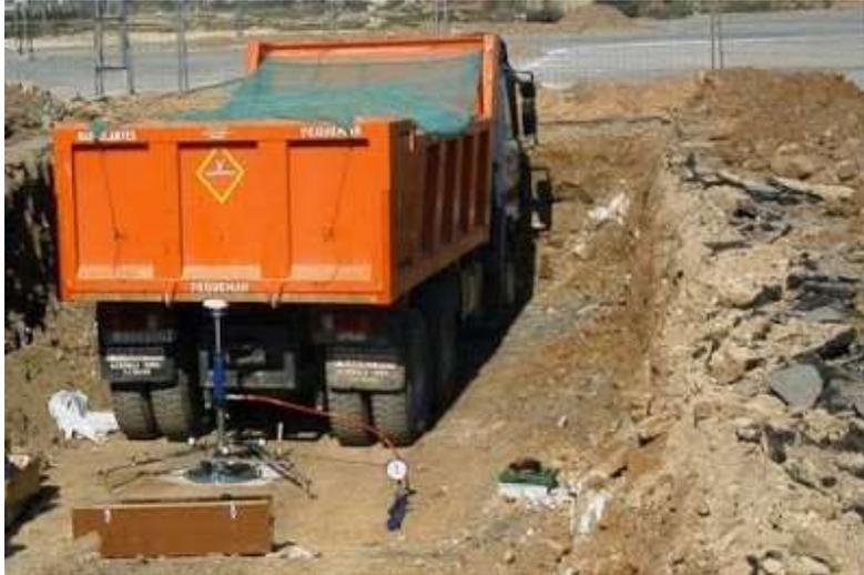
**Figura 6-3 Equipo de prueba de carga de placa.**
