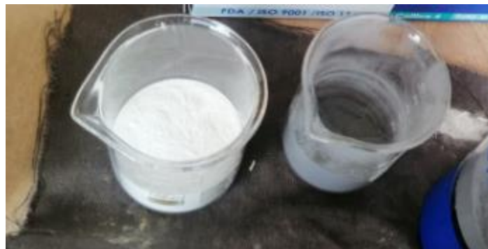
Imagen 1 Polvo de alúmina y polvo de TPU
