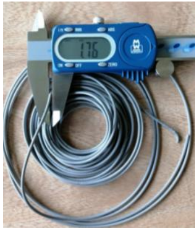
Imagen 8 Filamento compuesto de alúmina, EVA y ácido esteárico
