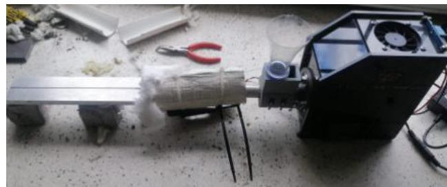
Imagen 4 Extrusora de filamento compuesto guiada por un tornillo sin fin
