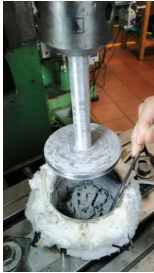
Imagen 3 Proceso de pelletización a partir de la herramienta fabricada
