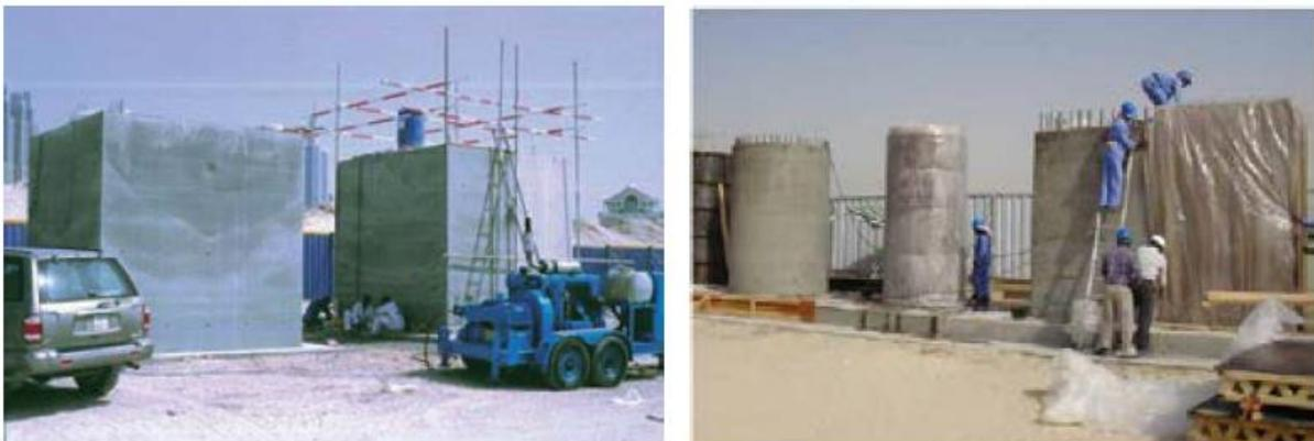
**Figura 1.4 Probetas a escala real en el Burj Khalifa**
