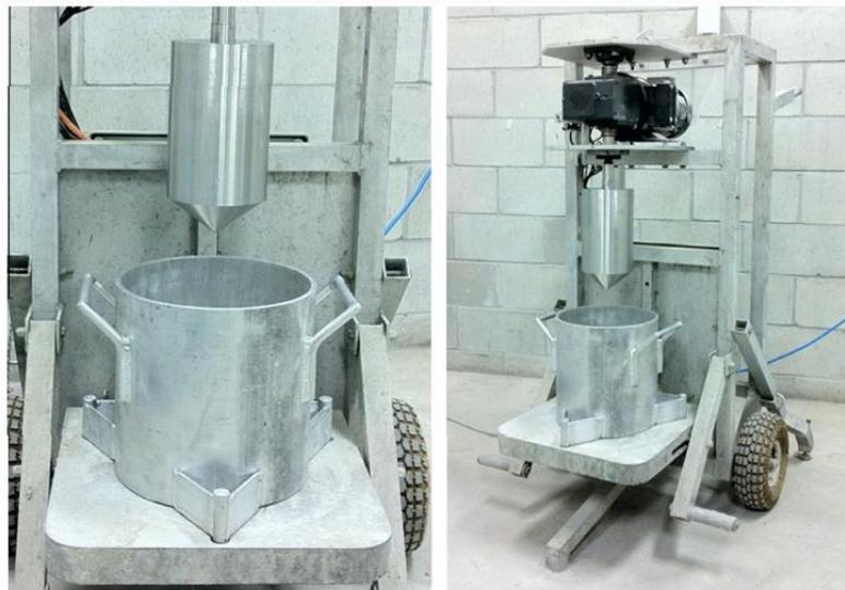
**Figura 1.5 Tribómetro portable para obras**
