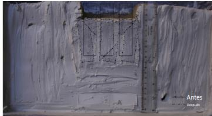
Figura 6 Comportamiento de falla columnas suelo - cemento. Fuente: Ahmad S, et al, 2016.
