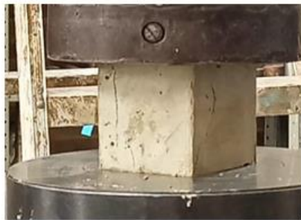
Figura 11 Fallas de los cubos de mezcla suelo-cemento. Fuente: Propia.
