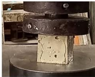
Figura 11 Fallas de los cubos de mezcla suelo-cemento. Fuente: Propia.
