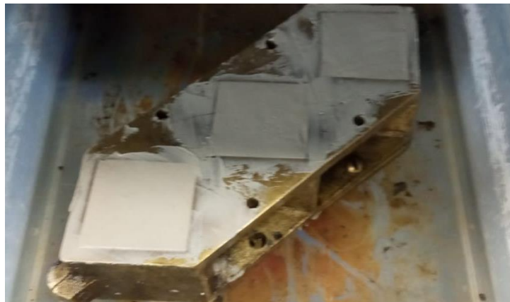
Figura 10 Cubos de mezcla suelo-cemento. Fuente: Propia.
