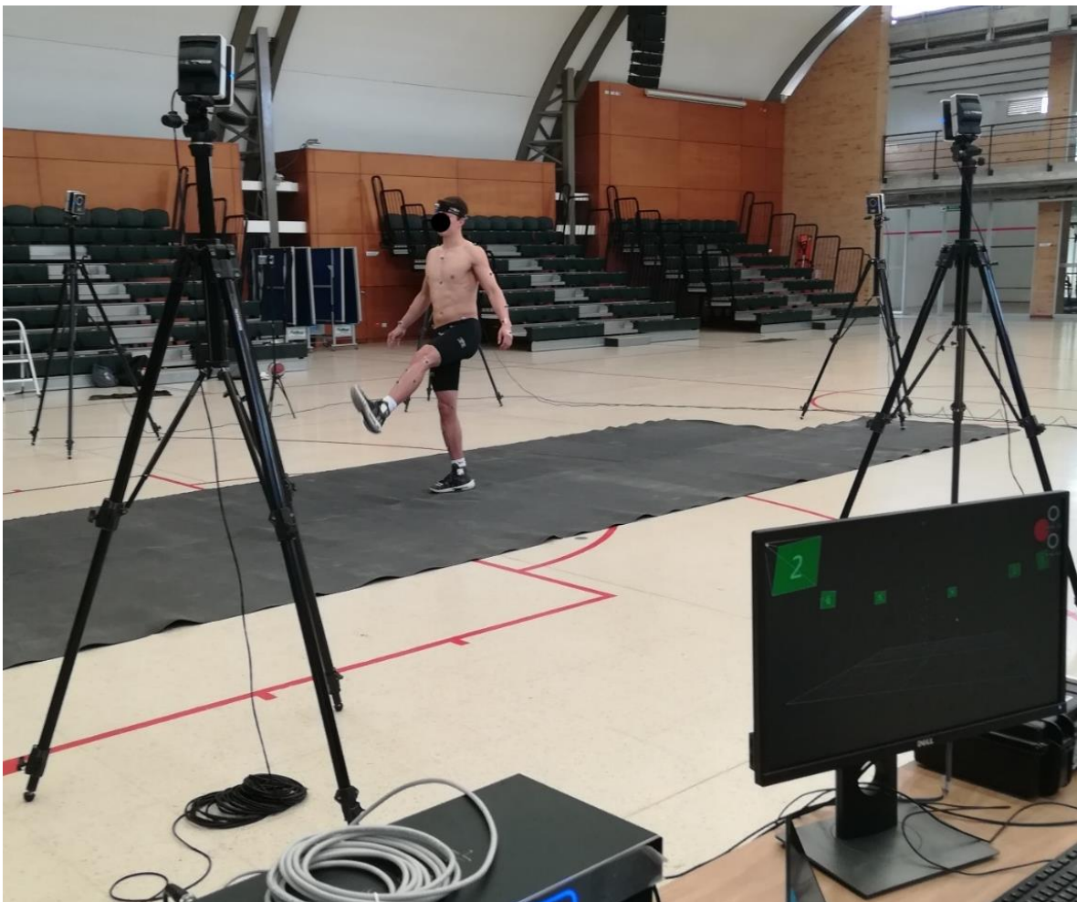
Figura 6. Calibración del sistema jugador-equipos de adquisición de datos
