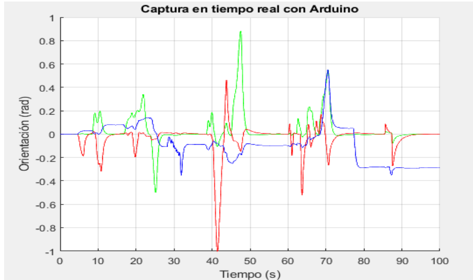
Figura 5. 10 Respuesta del sensor con el filtro de Kalman aplicado, MATLAB
