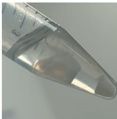
Figura 4.1: Fibra de colágeno producida por las condiciones piel-PBS-0,5:1.
