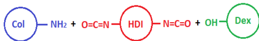
Figura 4.14: Reacciones entre el colágeno, HDI y dextrano para la síntesis del hidrogel. Fuente propia.
