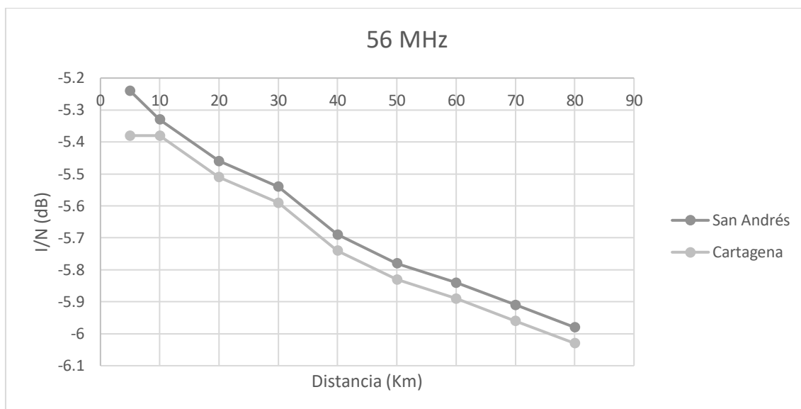
Figura 46. Gráfico lineal para el parámetro I/N con ancho de banda de 56MHz para la evaluación del Escenario 2.
