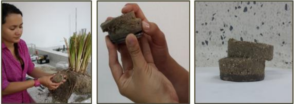
Foto 15 Preparación de muestra para ensayo de corte directo y falla de la muestra
