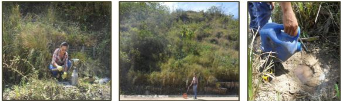
Foto 19 Toma de densidades en campo, mediciones de la zona y permeabilidad del material
