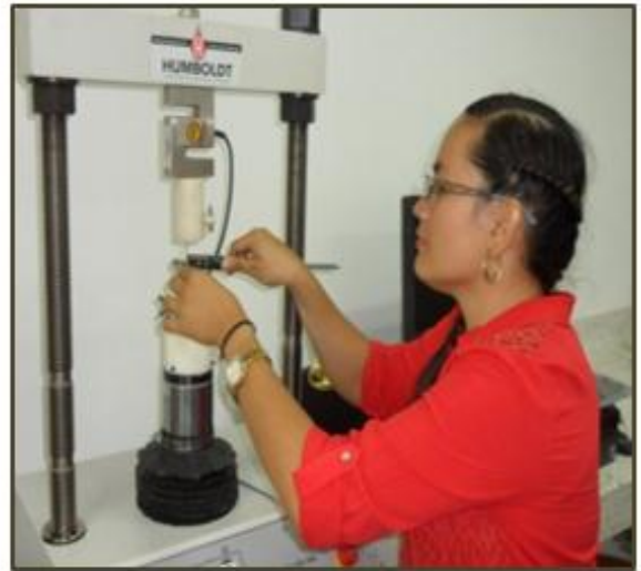
Foto 24 Colocación de la raíz del pasto Vetiver y medición del diámetro para ensayo a tracción
