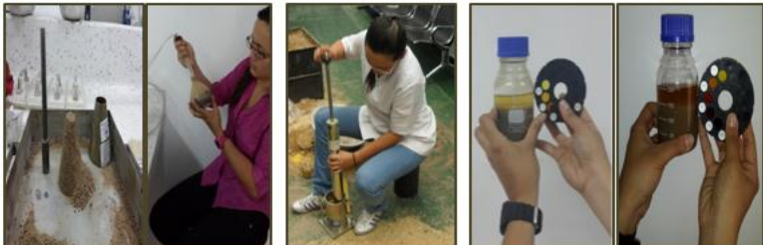
Foto 18 Ensayos de Gravedad específica en arenas, Densidad máxima, y Contenido de materia orgánica
