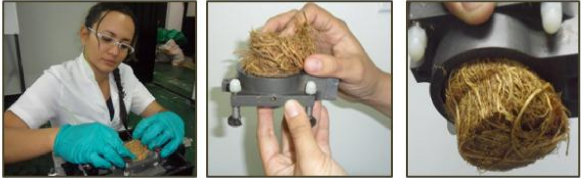
Foto 27 Ensayo de resistencia al corte con raíces de pasto Vetiver
