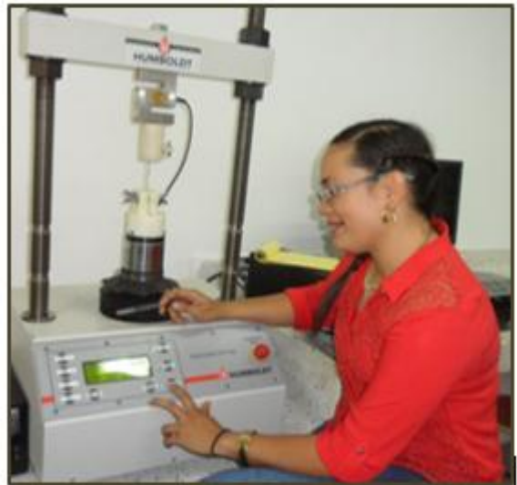
Foto 25 Ejecución ensayo a tracción de la raíz del pasto Vetiver en equipo Humboldt HM 3000
