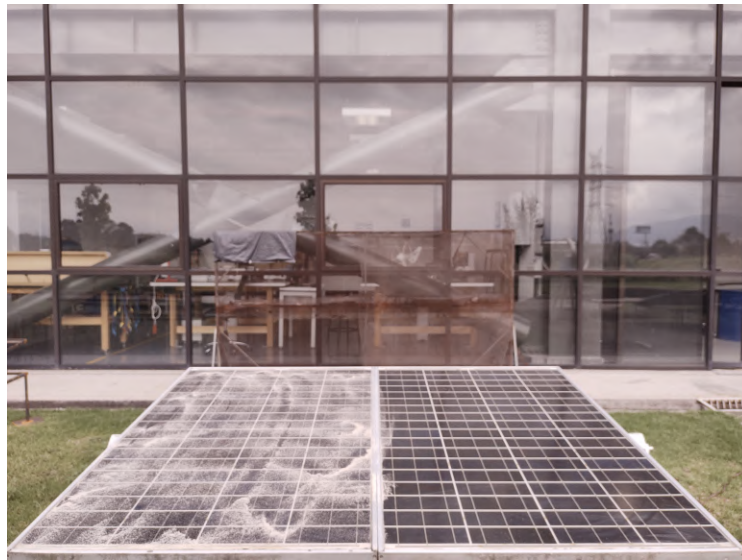
Figura 5.1: Montaje en laboratorio-polvo. Fuente: Elaboración propia
