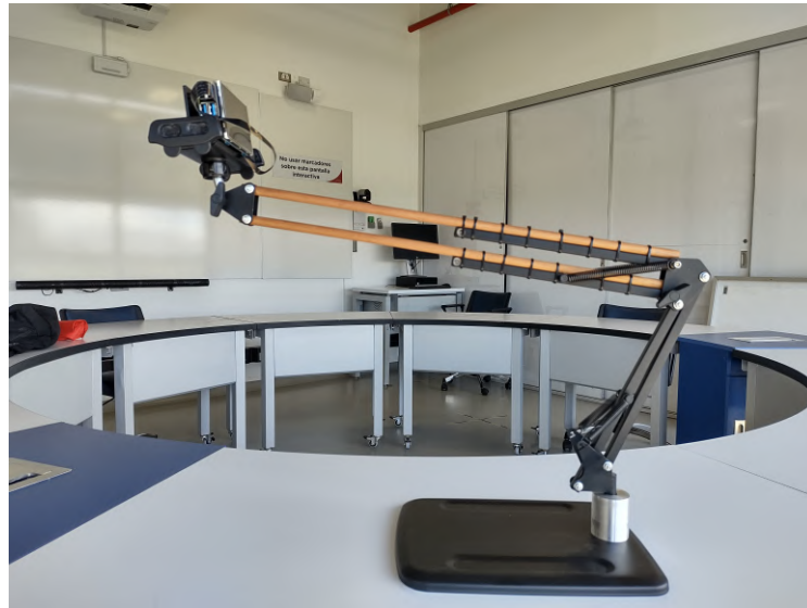
Figura 3.18: Modelo final del sistema embebido de monitoreo térmico. Fuente: Elaboración propia.
