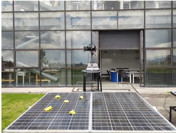
Figura 5.8: Montaje en laboratorio-heces de ave. Fuente: Elaboración propia
