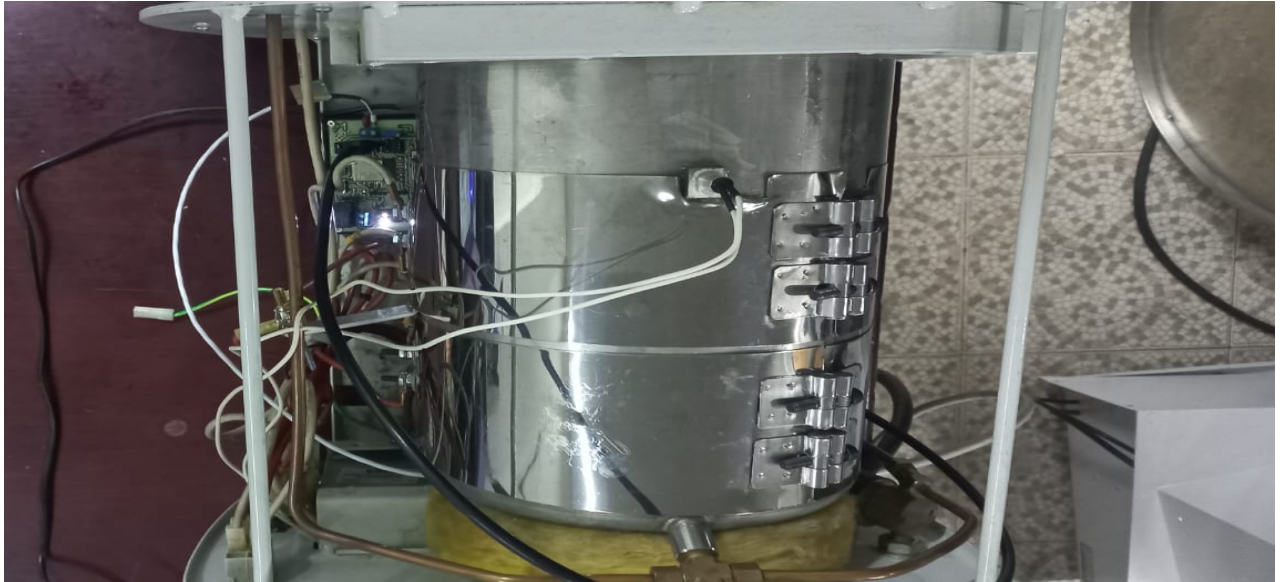
Figura 38. Vista superior autoclave con el sistema de calificación operacional.(P1) Fuente: (Elaboración propia)
