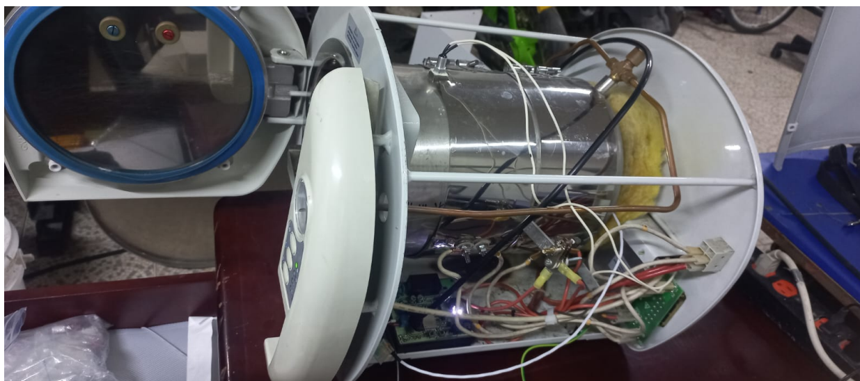
Figura 37. Vista lateral autoclave con el sistema de calificación operacional (P1). Fuente: (Elaboración propia)
