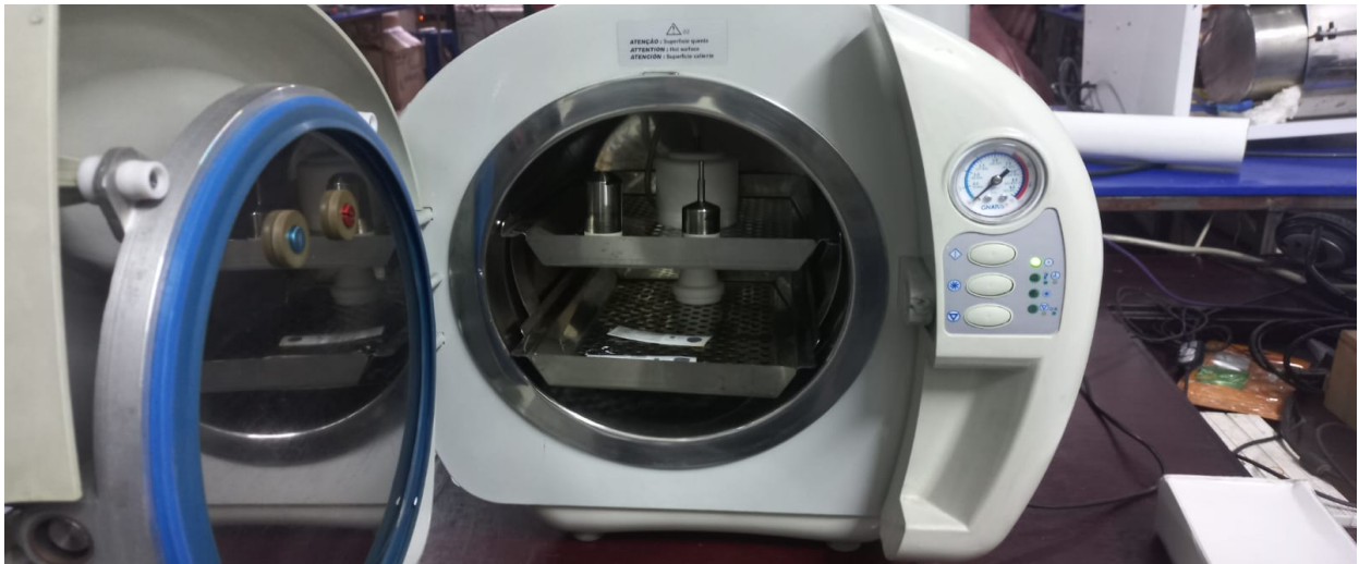
Figura 40. Vista frontal autoclave con los indicadores químicos y biológicos(P1). Fuente: (Elaboración propia)
