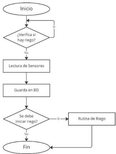
**Figura 47** Diagrama de flujo de supervisión por línea de riego
