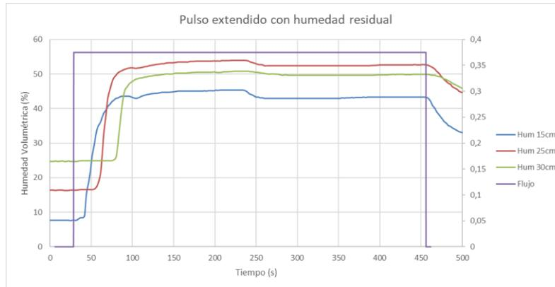
**Figura 15** Pulso de agua a 0,375 L/min con humedad residual en todo el sustrato
