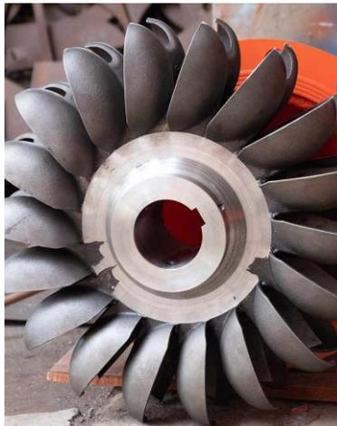
**FIGURA 5.5.** Turbina tipo Pelton. (<https://www.enelgreenpower.com/es/learning-hub/energias-renovables/energia-hidroelectrica/turbina-hidroelectrica>, 2020).
