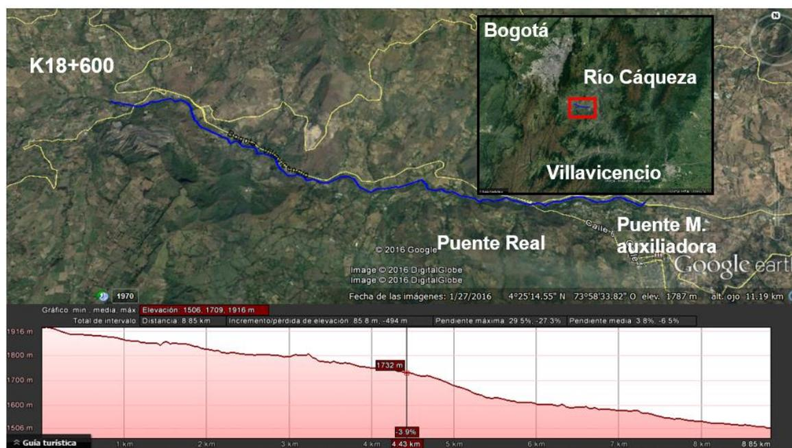
FIGURA 4.4. Perfil longitudinal del río Cáqueza. Tomado de Google Earth 2016.
