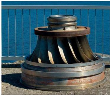
**FIGURA 5.6.** Turbina tipo Francis. (<https://www.enelgreenpower.com/es/learning-hub/energias-renovables/energia-hidroelectrica/turbina-hidroelectrica>, 2020).
