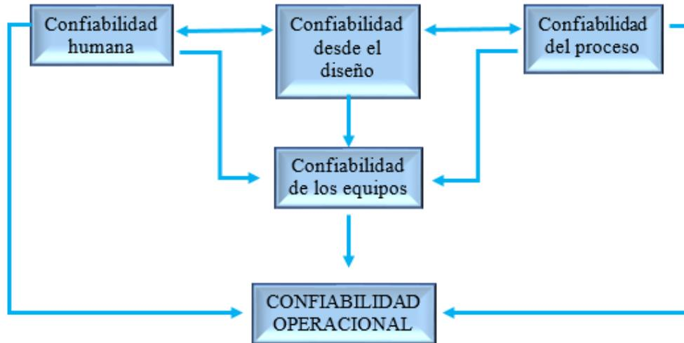
Figura 1.1: Pilares de la confiabilidad operacional (Amendola).
