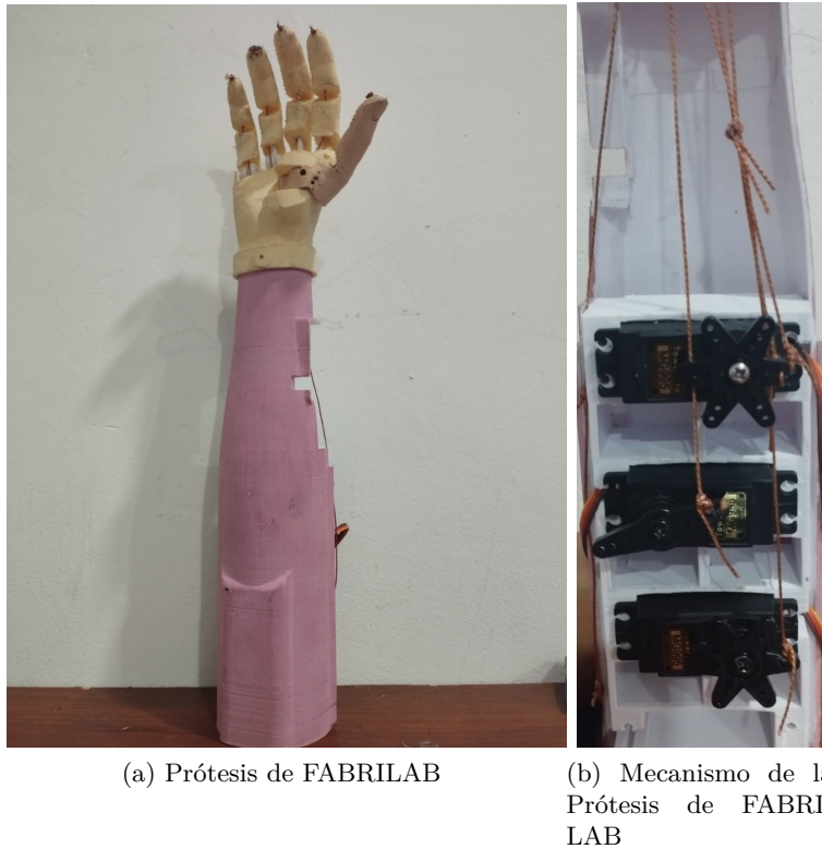
Figura 5.2: Prótesis y su mecanismo para validación del modelo K-NN desarrollado de marca FABRILAB
