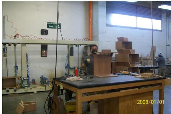
Foto No 5. Subproceso Ensamble.
