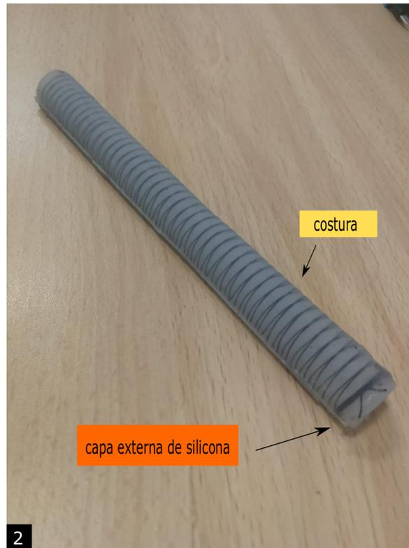
Figura 4.4: Resultado final actuador de fibra reforzada.
