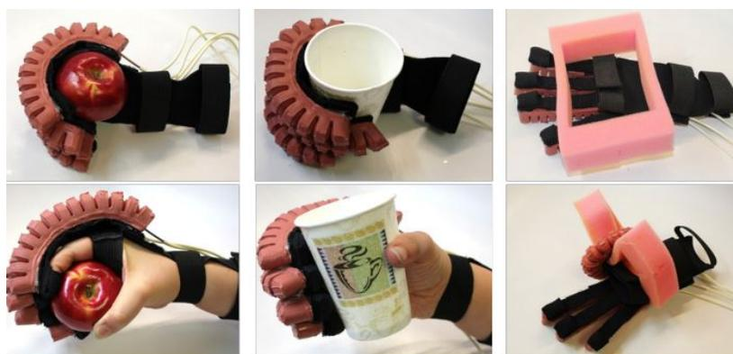
Figura 2.10: Actuador PneuNet en una aplicación para asistencia en guante de rehabilitación tomado de [50].
