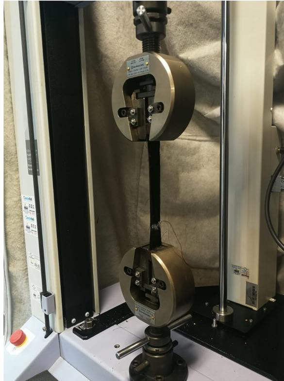
Figura 4.8: Imagen tomada en el ensayo de tensión, donde se puede observar el fallo de la probeta correspondiente al material textil negro.
