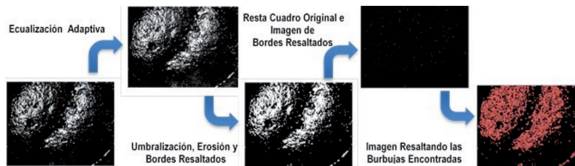
Figura 7. Procesamiento de la imagen de la superficie de la espuma cerca de la ER_{m\acute{a}x} . Fuente: Elaboraci\u00f3n propia.
