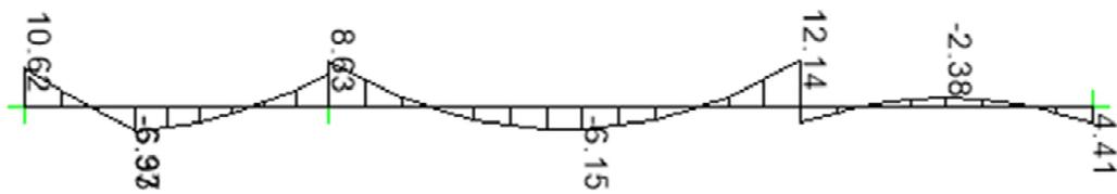
Figura 75 Momentos Viga Eje 5p entre Ejes Ap y Fp
