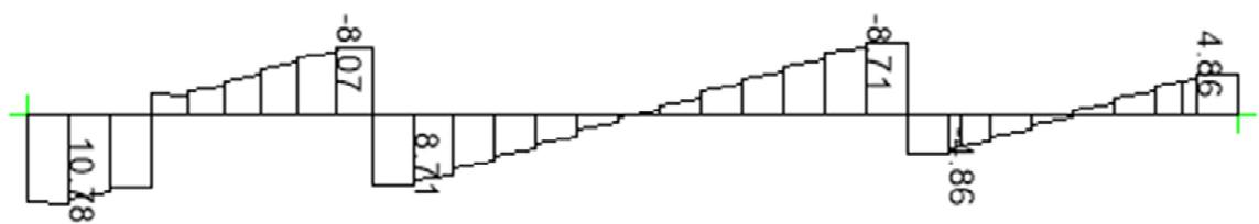
Figura 50 Cortante Viga Eje 5p entre Ejes Ap y Fp
