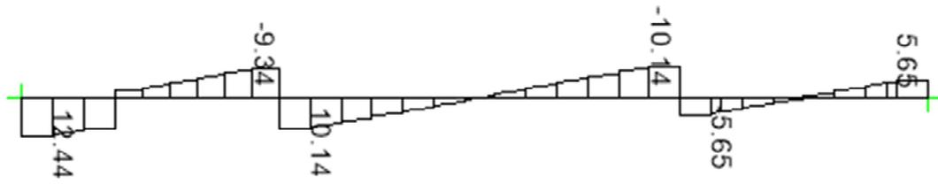
Figura 74 Cortante Viga Eje 5p entre Ejes Ap y Fp
