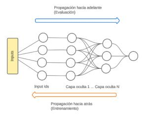
FIGURE 3.4: Propagación hacia adelante y hacia atrás
