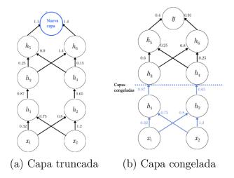
FIGURE 3.11: Técnicas de transferencia de conocimiento sobre redes neuronales de modelos pre-entrenados
