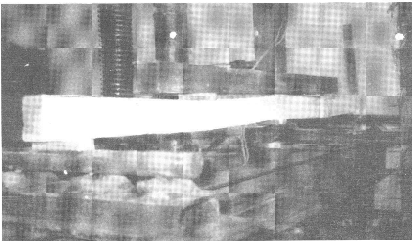
Figura 6. Ensayo de una viga continua de dos luces con cargas concentradas en el centro de cada luz.
