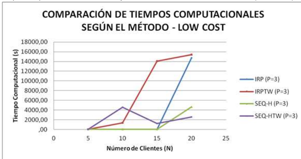
Gráfica 5 - 1 Comparación de tiempos computacionales según el método de optimización para 3 periodos con costos bajos de mantenimiento de inventario (Low Cost)
