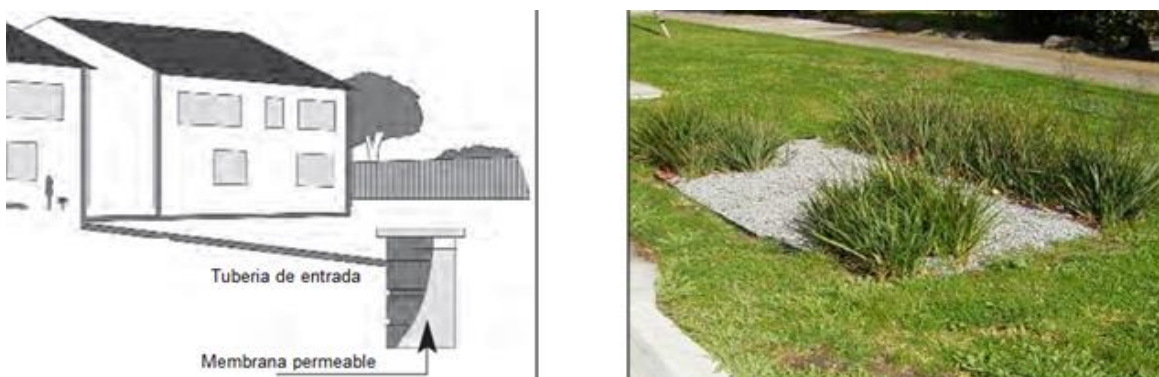
Figura 5.11 Pozo de infiltración (36) (2)
