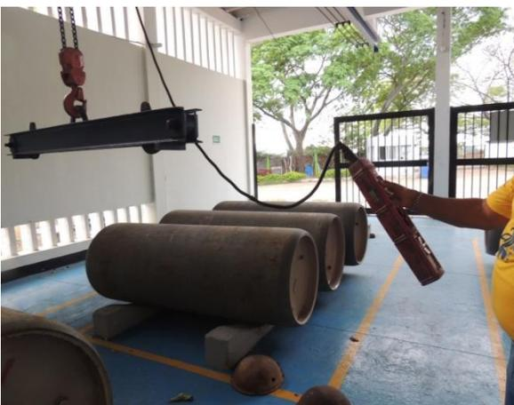
Figura 40. Precauciones en la manipulación de los cilindros con cloro. Fuente: Los autores
