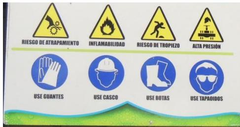
Figura 35. Señalización clara de factores de riesgo y Equipos de protección personal
