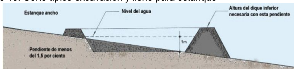
Gráfico 10. Corte típico excavación y lleno para estanque
