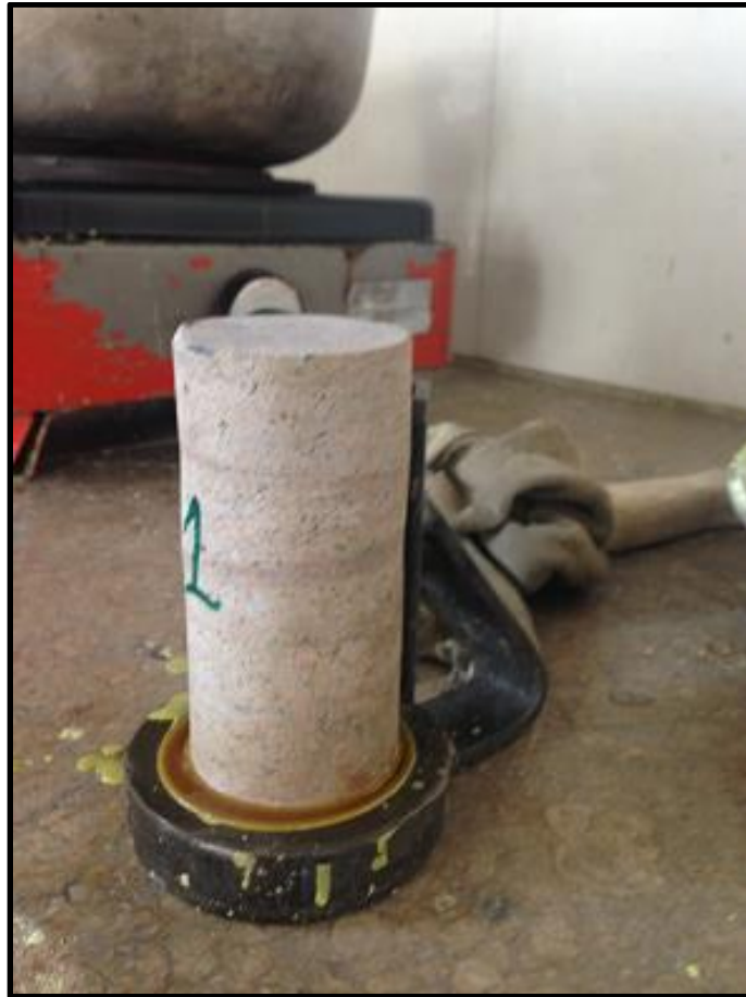
Figura 12 Refrentado de caras usando azufre en estado de líquido para cada muestra de roca ensayada. Fuente: Propia
