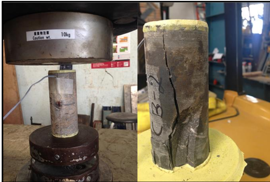
Figura 15 Ejecución de la prueba de compresión Uniaxial en la maquina universal con medición de deformación axial. Fuente: Propia
