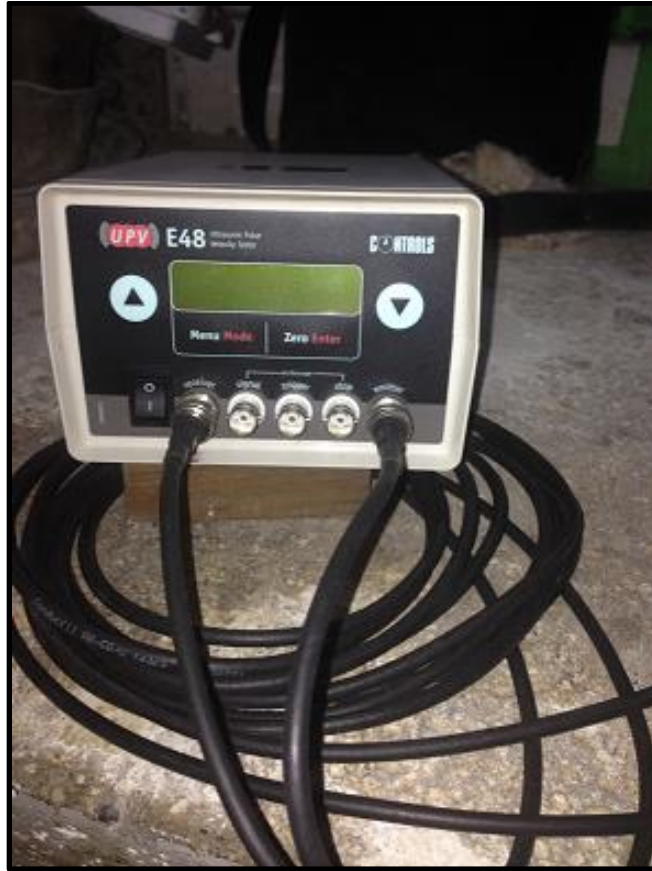
Figura 11 Equipo para la medición de la velocidad del pulso ultrasónico E48. Fuente: Escuela colombiana de ingeniería Fuente: Propia
