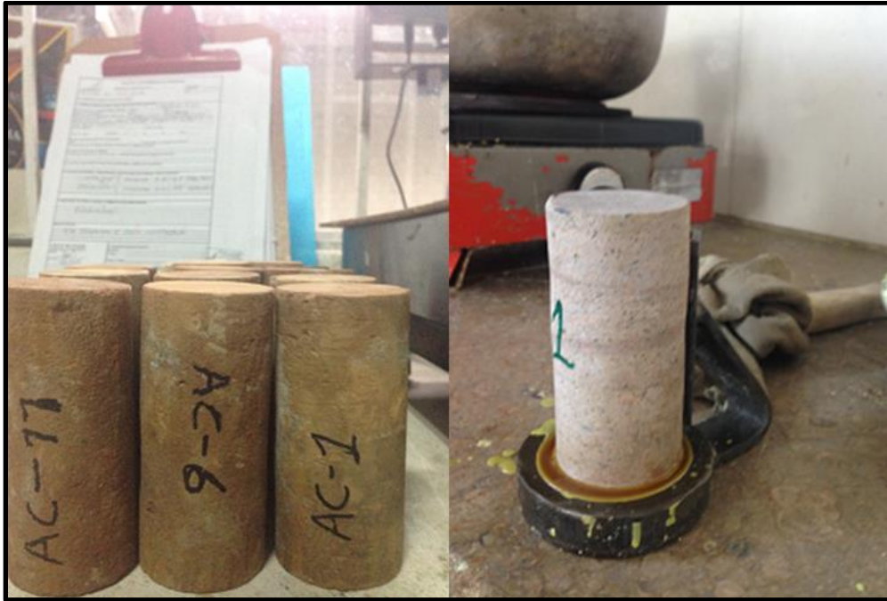
Figura 9. Preparación de muestras de roca para pruebas de velocidad de pulso ultrasónico y resistencia a la compresión simple. Fuente: Propia
