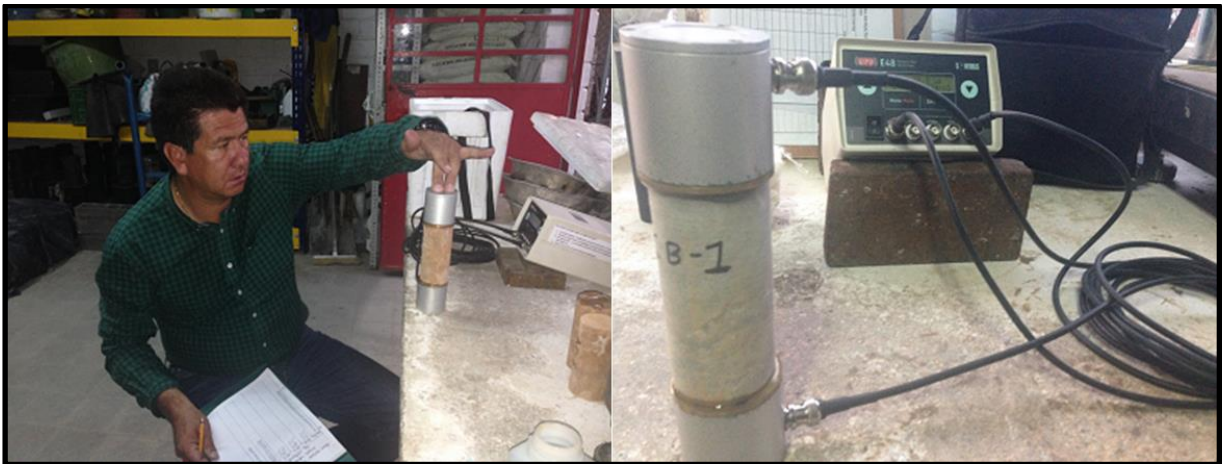
Figura 10 Ejecución de pruebas de velocidad de pulso ultrasónico para muestras de calizas, areniscas y arcillolitas. Fuente: Propia
