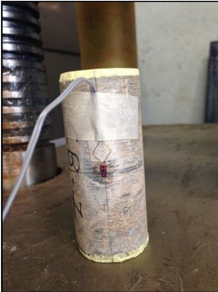
Figura 13 Instalación de Strain gage para medición de deformación axial durante la prueba de resistencia a la compresión simple. Fuente: Propia
