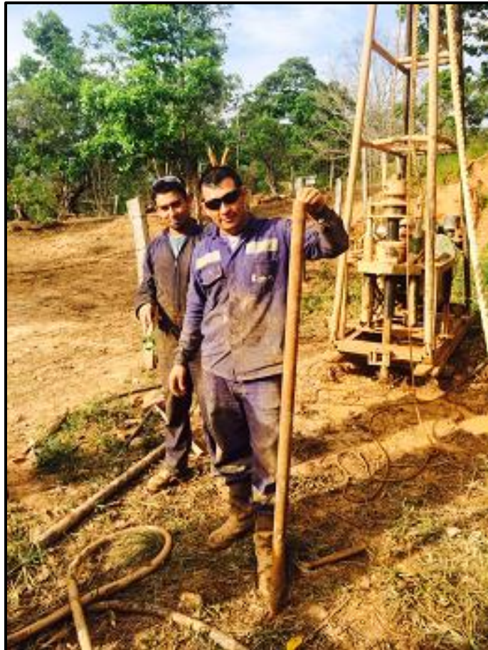
Figura 4. Extracción de muestreo de rocas arcillolitas sobre la Formación Caja, nótese el testigo de roca sana obtenido coordenadas Norte= 1068989, Este = 1176102. Fuente propia.
