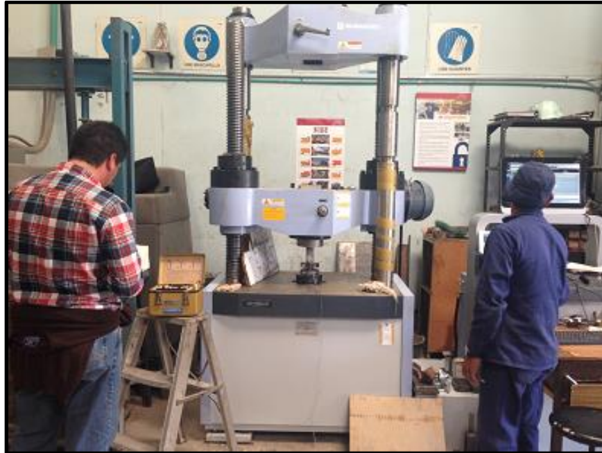
Figura 14 Equipo universal UH-1000kNX empleado para las pruebas de compresión simple. Fuente: Propia
