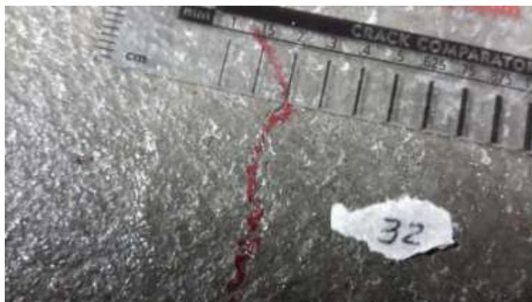
**Figura 6. Fisura de espesor entre 0.2 a 0.4mm. Fisura #34 M 3-30-C-0 (02 jun/14)**
