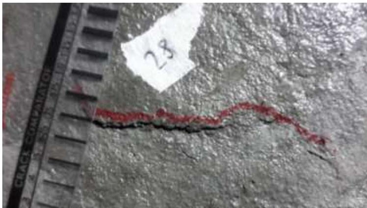
Figura 8 Cantidad de fisuras en mezclas con diferentes remplazos de agregados expuestas a diferentes velocidades de viento.
