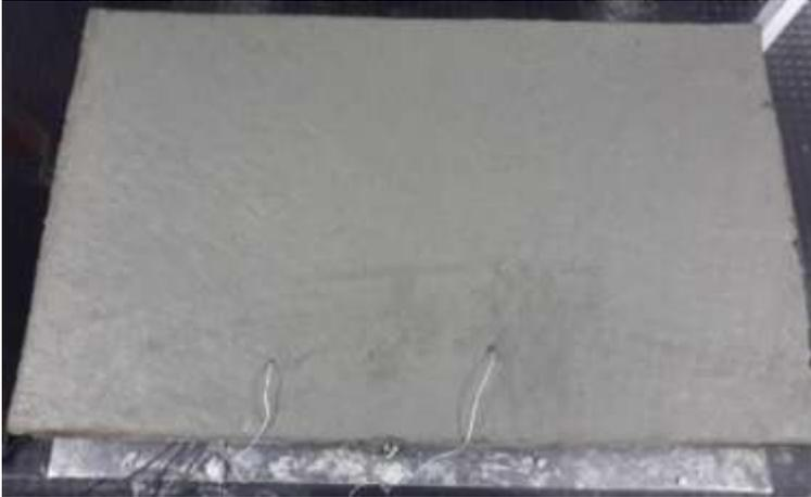
Figura 26 Losas con restricción de mezclas de ACR a expuesta a viento de 24 km/h
