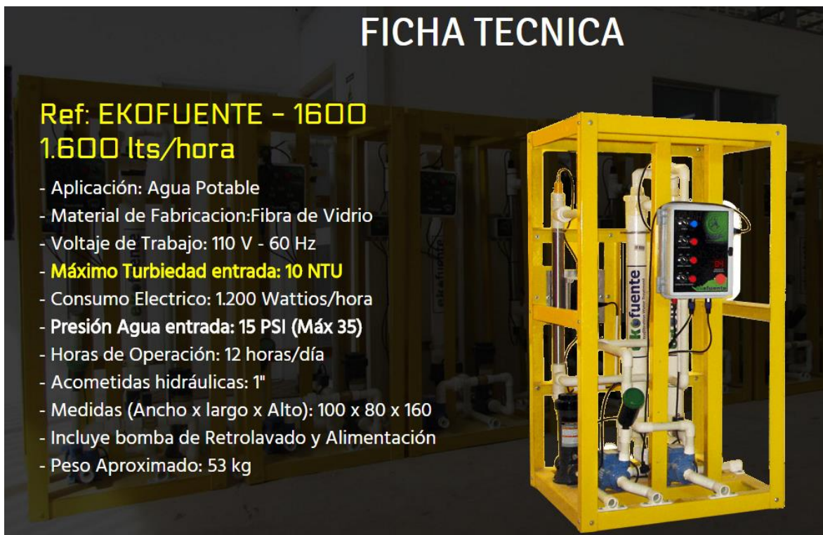
Ilustración 26 Planta Potabilizadora de Agua EKOFUENTE – 1600
