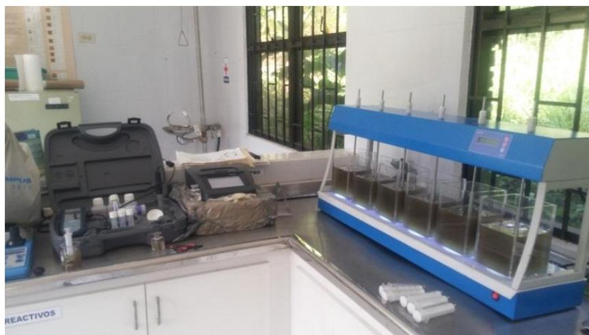
Figura 18. Ensayo de jarras
