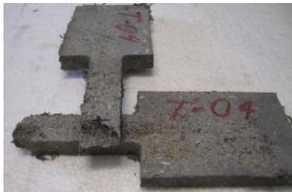
Figura 4-9: Modo de falla en centro de muestra tipo probeta, ensayo a tensión. Fuente: Autor
