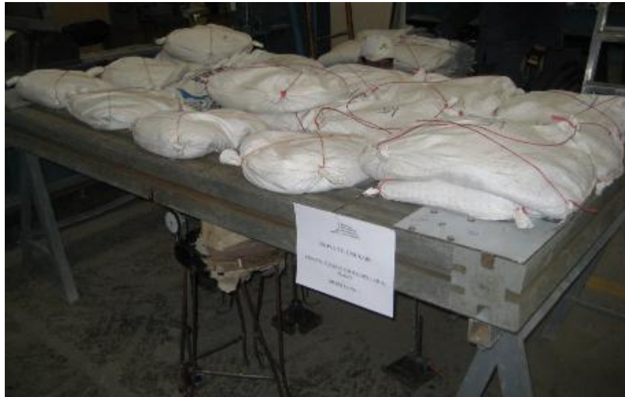
Figura 4-45: Colocación de carga sobre muestra 1 para ensayo de carga uniforme perpendicular al plano del muro. Fuente: Autor.
