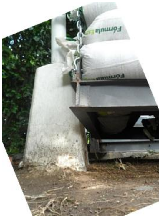
Figura 4-59: Detalle de bandeja con carga apoyándose en pedestal de concreto no tenido en cuenta para ensayo. Fuente: Autor
