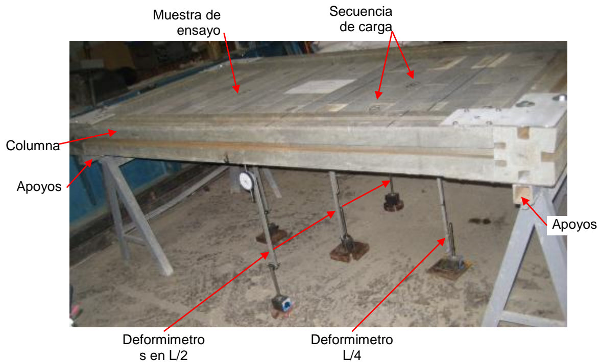
Figura 3-31: Montaje ensayo de carga uniforme sobre muros completos. Fuente: Autor
