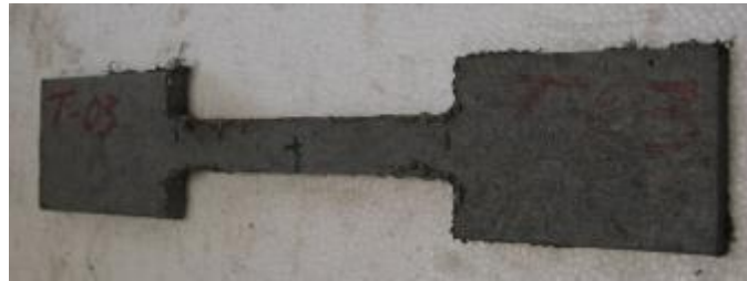
Figura 3-4: Montaje Muestra tipo probeta ensayo a tensión. Fuente: Autor
