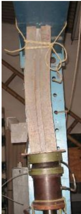
Figura 4-21: Modo de falla por pandeo de columna de 0,80m en ensayo a compresión.
