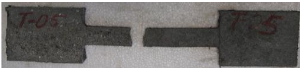
Figura 4-10: Modo de falla a 1/3 de la longitud de muestra tipo probeta, ensayo a tensión. Fuente: Autor
