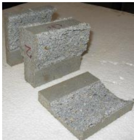
Figura 4-13: Modo de falla sección de bloque ensayada a cortante. Fuente: Autor.
