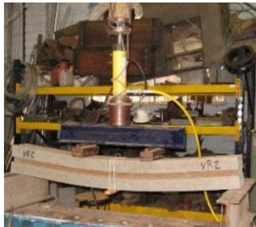
Figura 4-24: Flexión en viga de cimentación y remate con pestaña de 1,16m durante ensayo a flexión. Fuente: Autor.
