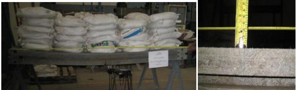
Figura 4-46: Deflexión del muro sometido a ensayo de carga uniforme perpendicular al plano del muro. Fuente: Autor.
