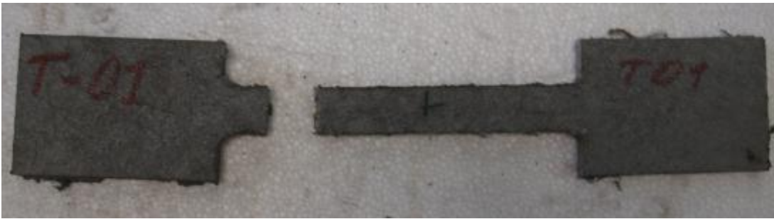
Figura 4-8: Modo de falla en extremo de muestra tipo probeta, ensayo a tensión. Fuente: Autor
