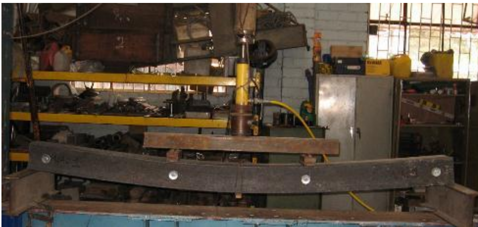
Figura 4-32: Flexión en vigas vigueta de 2,40m ensayo a flexión. Fuente: Autor.
