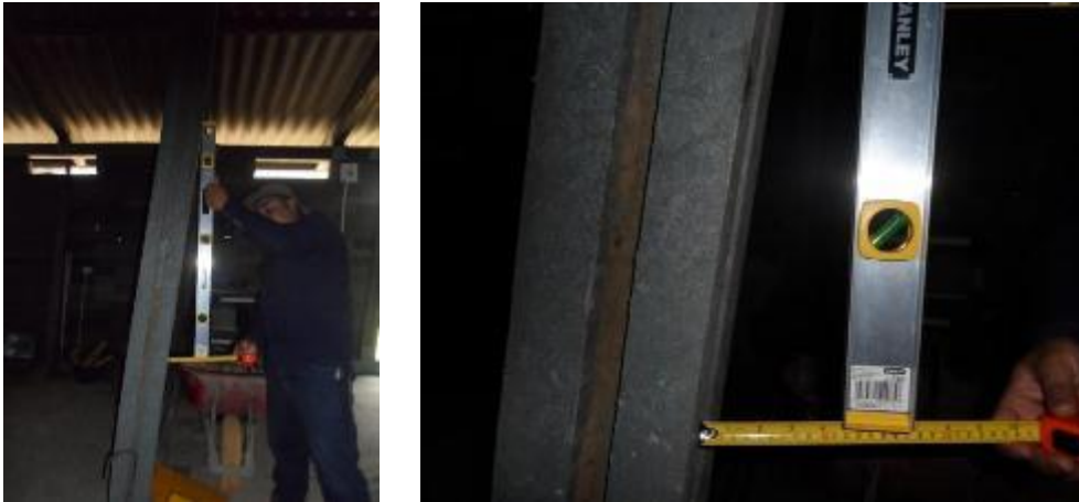
Figura 4-62: Rotación en columna 2 del pórtico #2 durante ensayo de CARGA a estructura tipo vivienda a escala real. Fuente: Autor
