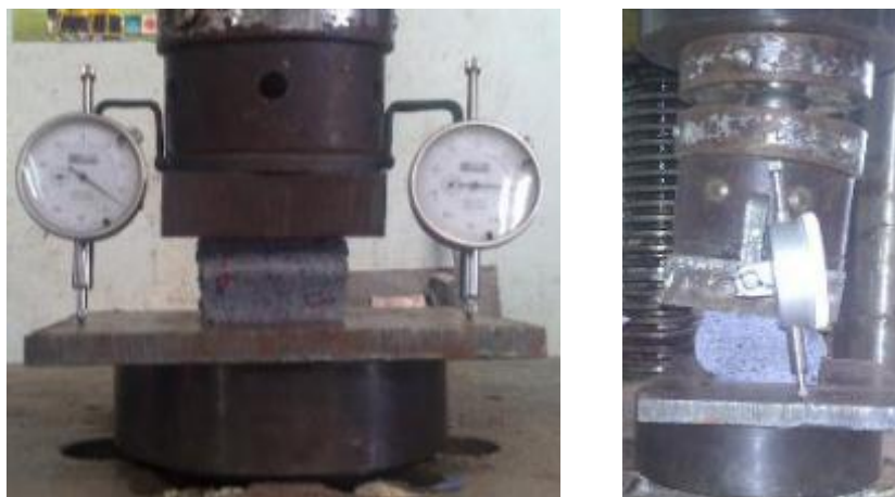
Figura 4-1: Fallas de dos muestras tipo cubo al finalizar ensayo a compresión en dirección X. Fuente: Autor.
