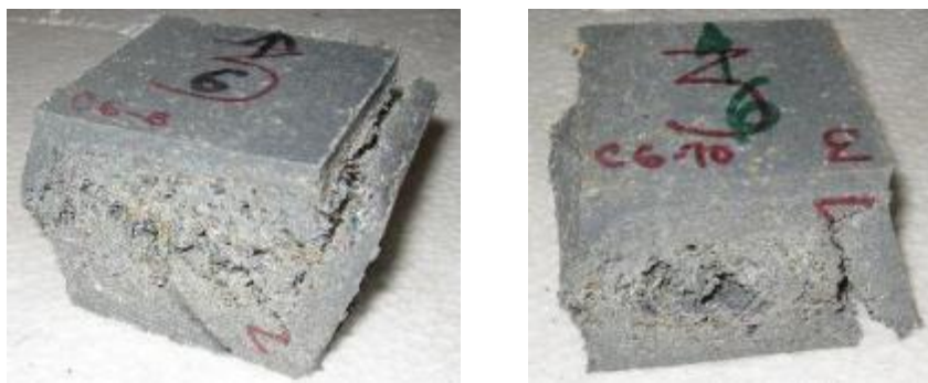
Figura 4-6: Modo de falla de muestras tipo cubo en ensayo a compresión en dirección Z. Fuente: Autor.
