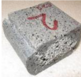
Figura 4-4: Modo de falla de muestra tipo cubo en ensayo a compresión en dirección Y. Fuente: Autor.
