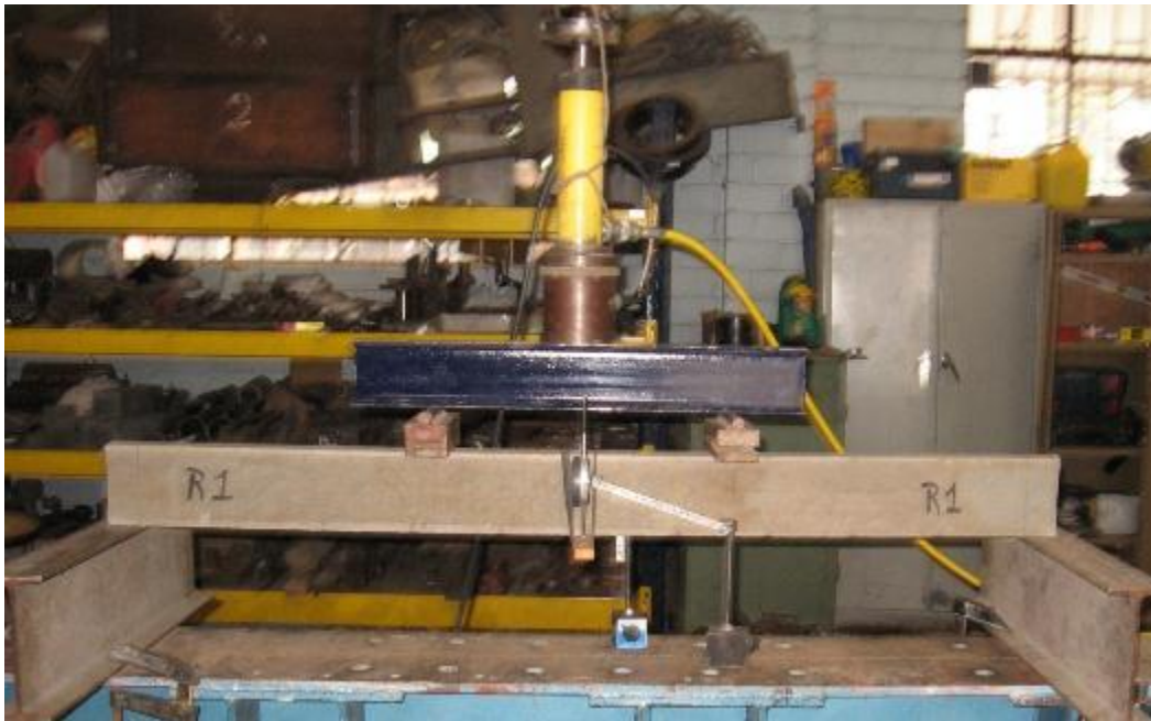
Figura 4-28: Flexión en viga vigueta de 1,50m ensayo a flexión. Fuente: Autor.
