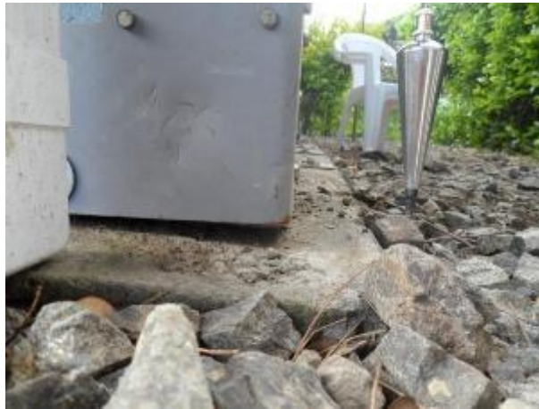
Figura 4-64: Levantamiento de columna de esquina, durante ensayo de CARGA a estructura tipo vivienda a escala real. Fuente: Autor
