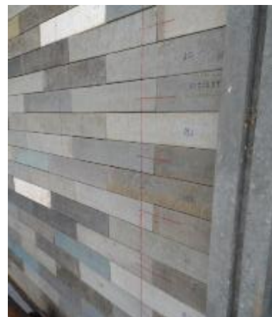
Figura 3-45: Marcas de referencia para medir desplazamientos locales. Fuente: Autor.
