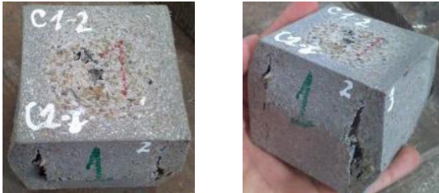
Figura 4-2: Modos de fallas de dos muestras tipo cubo en ensayo a compresión en dirección X. Fuente: Autor.
