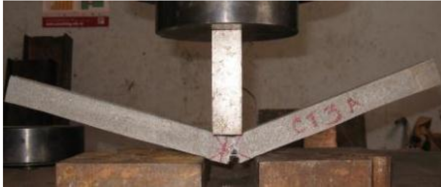
Figura 4-15: Modo de falla en el centro de luz, ensayo a cortante. Fuente: Autor.
