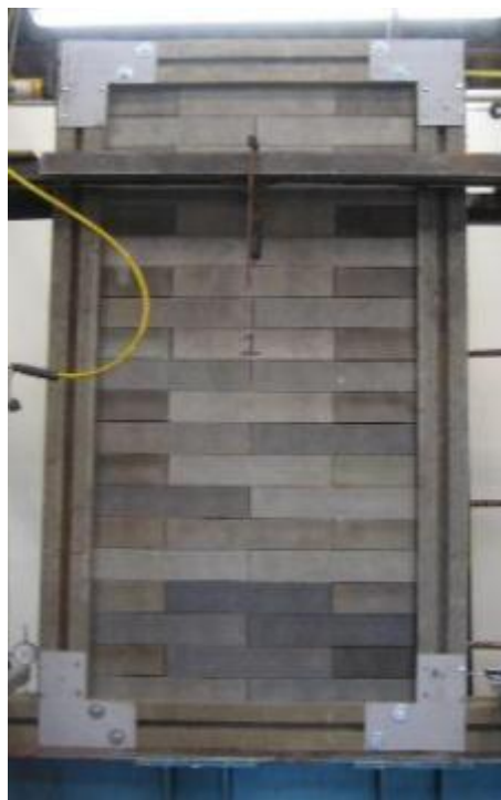
Figura 3-24: Muros completos a escala real. Fuente: Autor
