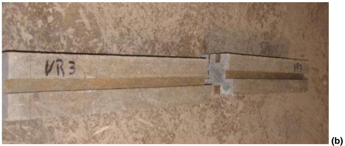
Figura 4-25: (a) y (b) Modo de falla en centro de luz de la viga durante ensayo a flexión en viga 1,16m de cimentación y remate con pestaña. Fuente: Autor.
