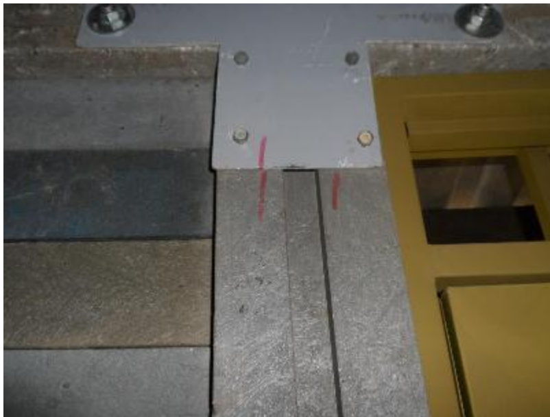
Figura 4-63: Rotación en columna 3 del pórtico #3 durante ensayo de CARGA a estructura tipo vivienda a escala real. Fuente: Autor
