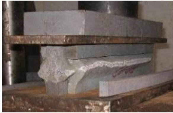
Figura 4-16: Fallas de dos muestras tipo cubo al finalizar ensayo a compresión en dirección Z. Fuente: Autor.
