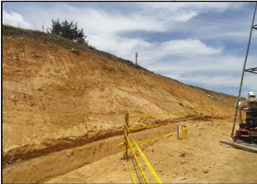
Fotografía 3-1. Aspecto de la unidad de suelos residuales de anfibolita en la zona de estudio. Fuente: Estudio suelos Ecopetrol,2014
