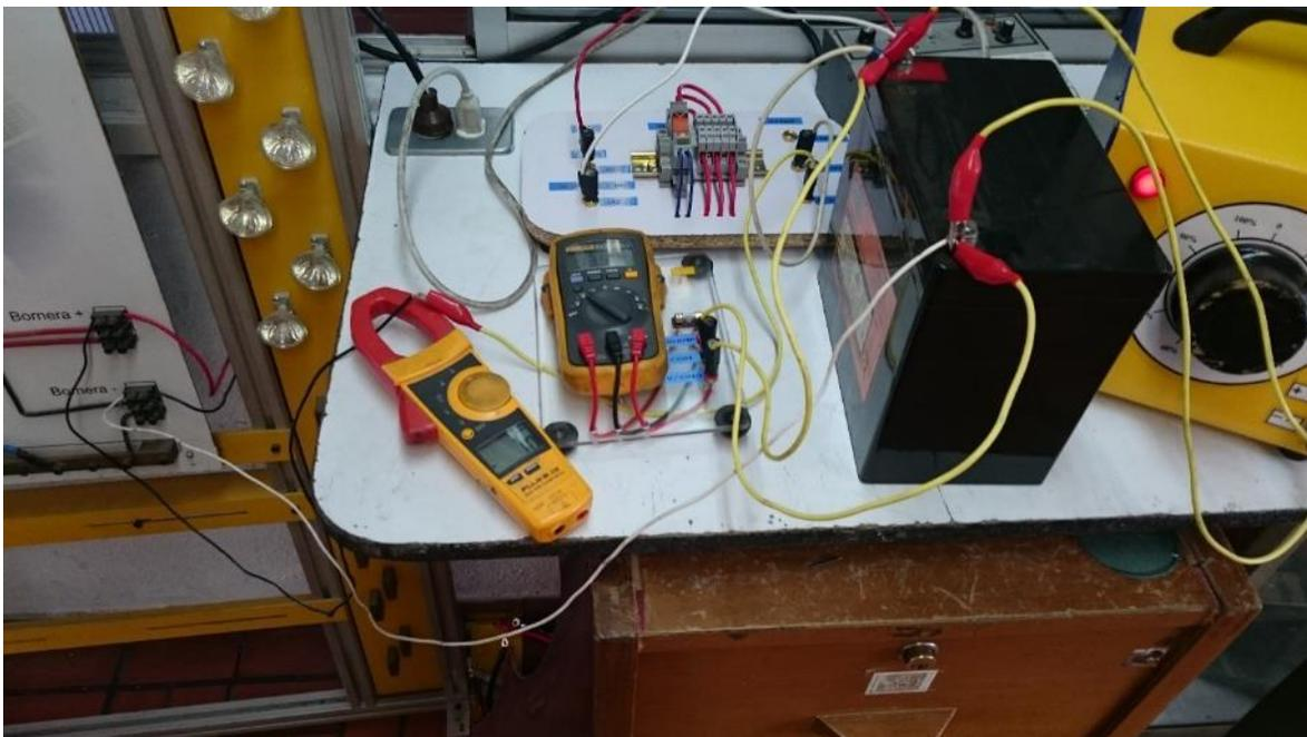
Se ejecutaron más de quince (15) pruebas de apertura y cerrado para corrientes diferentes hasta un máximo de 15 amperios que es la carga máxima que va a soportar el prototipo. Donde se verifica el correcto funcionamiento de los relés seleccionados.
