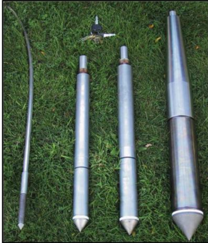
Fotografía No. 7. Diferentes tamaños de cono (de izquierda a derecha: 2cm 2 , 10cm 2 , 15 cm 2 y 40cm 2 ). Fuente: P. K. Robertson y Gregg Drilling & Testing 2010
