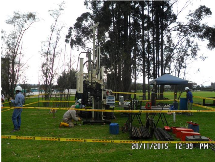
Fotografía No. 13. Prueba de campo SDMT (IGR SAS). Fuente: Propia, 2016.
