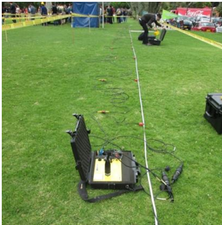
Fotografía No. 10. Prueba de campo Geofísica (Jeoprobe). Fuente: Tomada de Rodríguez E (Mayo, 2015), Resultados Practica Curso de Exploración y Caracterización- Sociedad Colombiana de Geotecnia.
