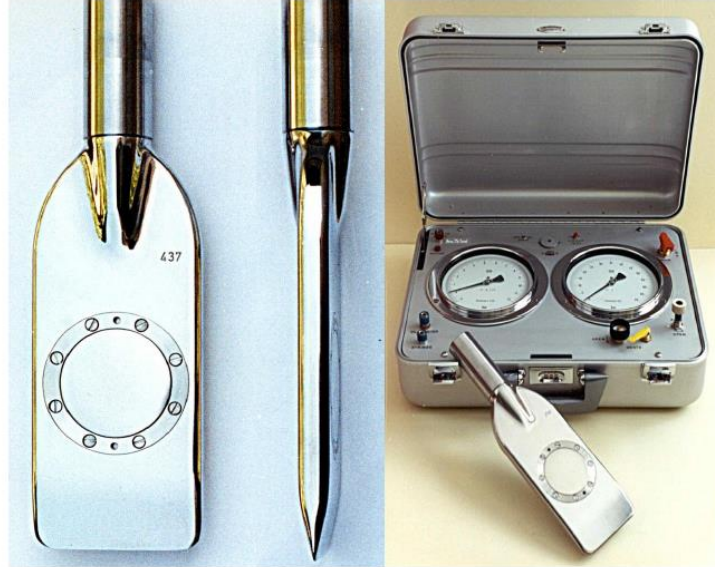
Figura No. 11. Dilatómetro de Marchetti (según Marchetti, 1980). Fuente: Marcelo Devincenzi, Igeotest, S.L. “El Ensayo del Dilatómetro de Marchetti”
