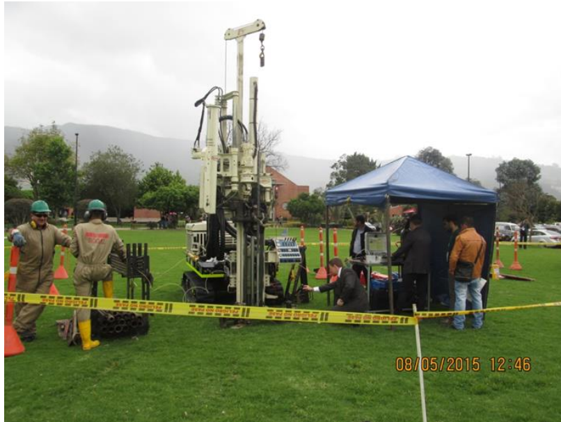
Fotografía No. 9. Prueba de campo SDMT (Marchetti – IGR). Fuente: Tomada de Rodríguez E (Mayo, 2015), Resultados Practica Curso de Exploración y Caracterización- Sociedad Colombiana de Geotecnia.
