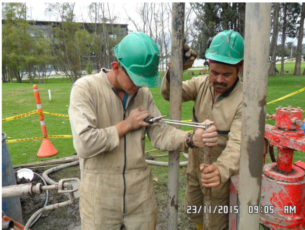
Fotografía No. 6. Ensayo de torsión con veleta de campo (VST). (SEGECI). Fuente: Propia, 2016.
