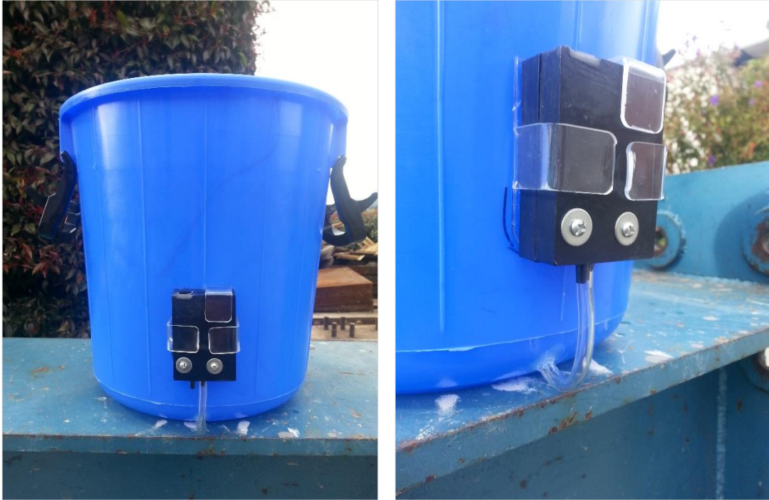
Figura 72. Tanque Para la Medición del Caudal de Salida
