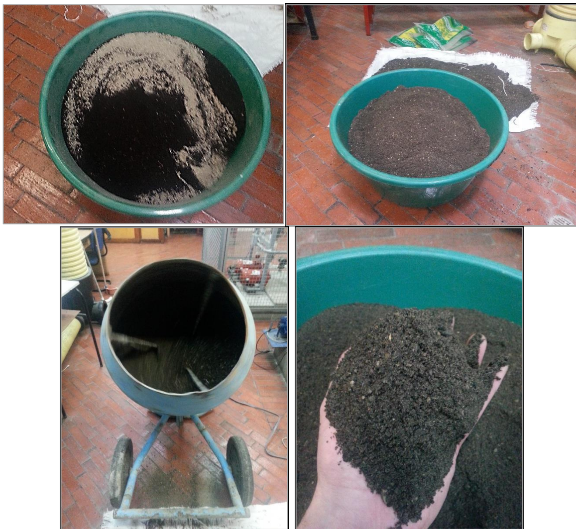
Figura 23. Proceso de Mezclado del Suelo
