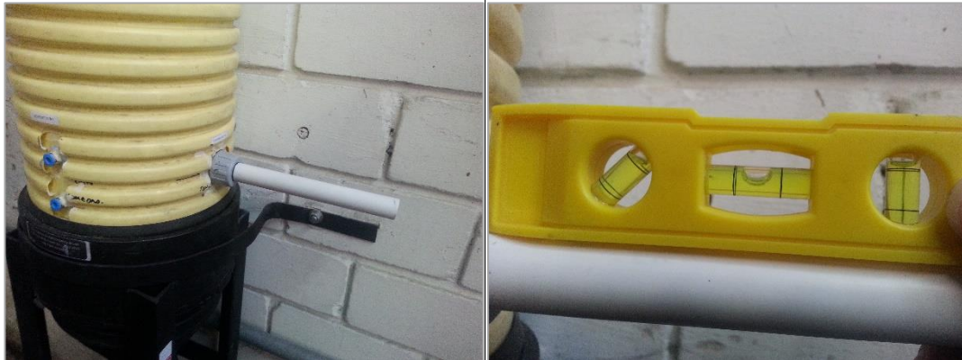
Figura 78. Instalación y Nivelación de Falsos Tensiómetros
