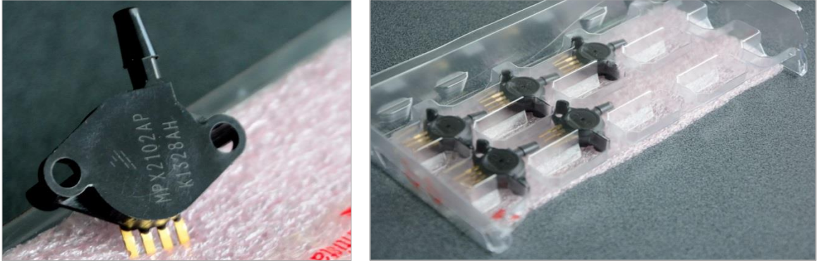
Figura 44. Sensor de presión MPX 2102AP
