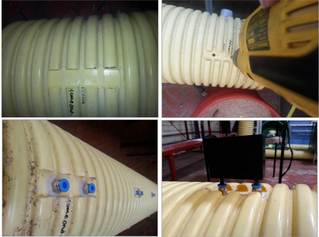
Figura 74. Acople de Higrómetros a la Columna de Suelo
