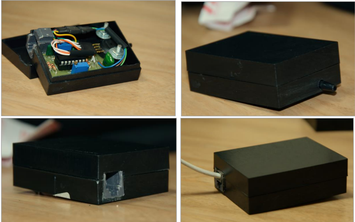
Figura 54. Detalle del Proceso Constructivo de la Caja del Transductor de Presión y Presentación Final del Transductor de Presión
