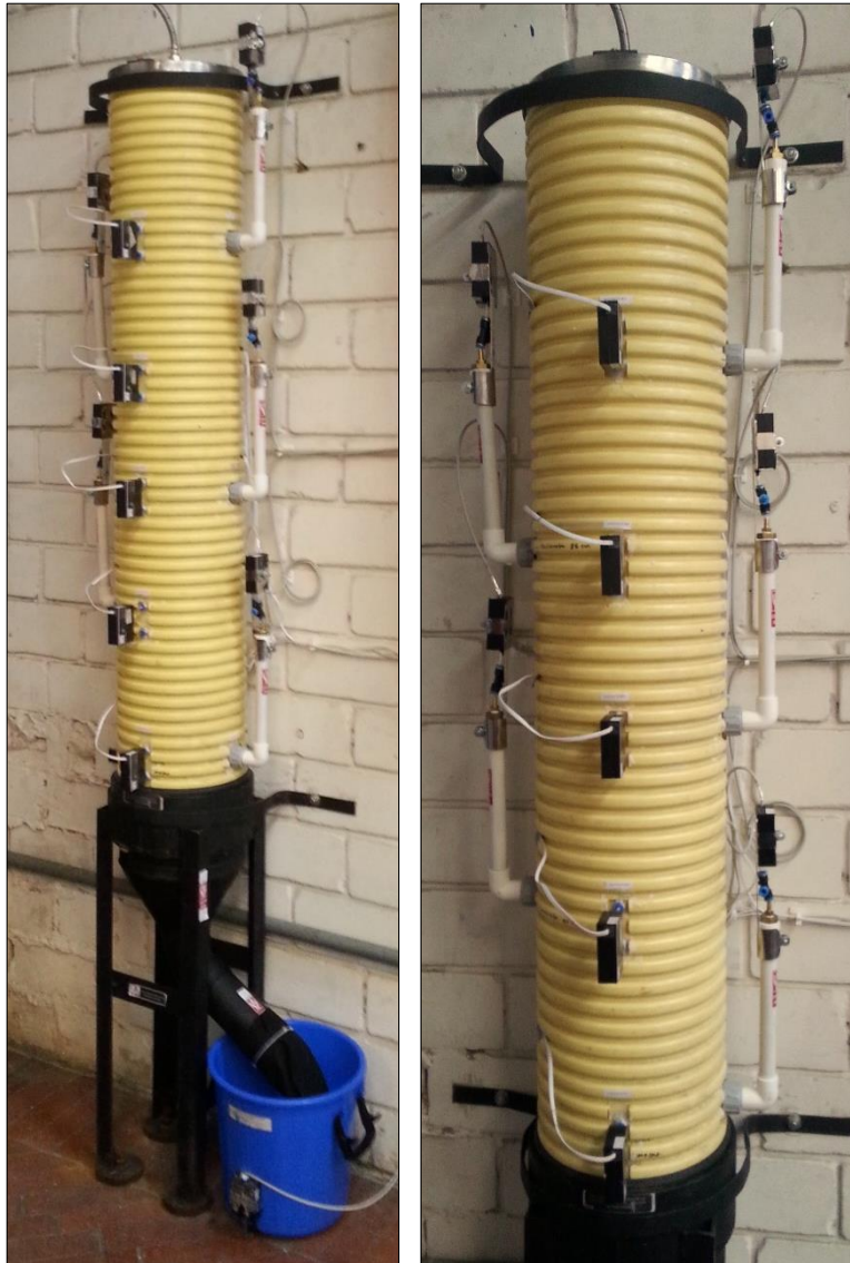
Figura 83. Montaje de Columna de Suelo en Proceso de Toma de Datos
