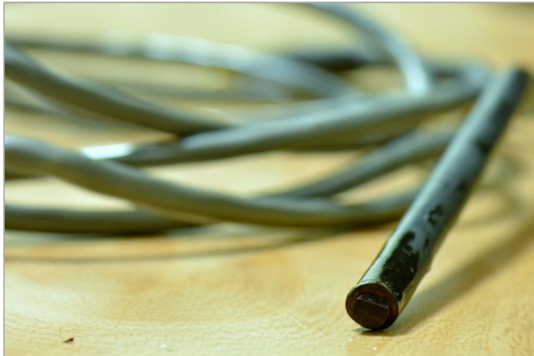
Figura 64. Medidor de Temperatura
