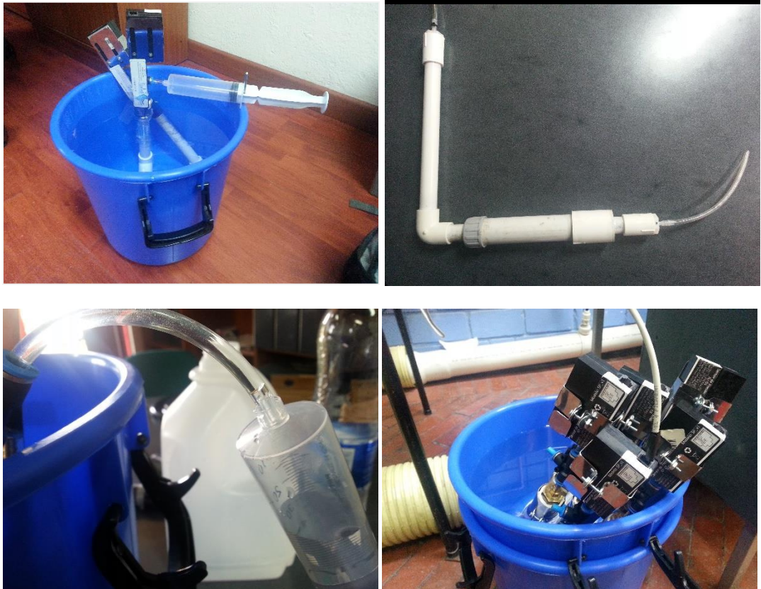
Figura 68. Proceso de Llenado de Tensiómetros
