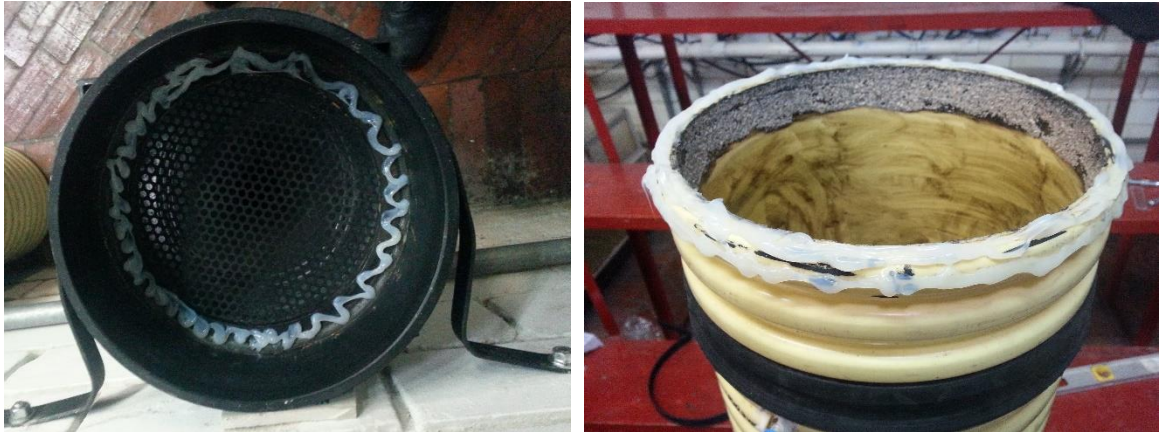
Figura 76. Proceso de Sellado con Silicona
