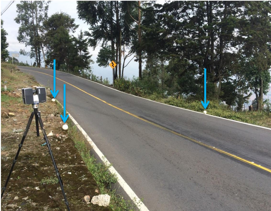
Figura 85. Equipo LiDAR terrestre, y las tres esferas de referencia. Fuente: Elaboración Propia.
