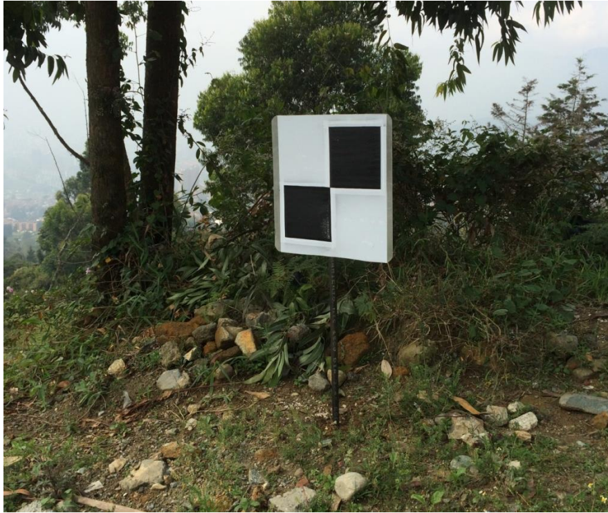
Figura 86. Señales de referencia fabricadas e instaladas. Fuente: Elaboración Propia.
