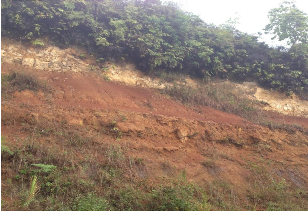
Figura 14. Escarpe, evidente señal de desplazamiento de material. Fuente: Propia.
