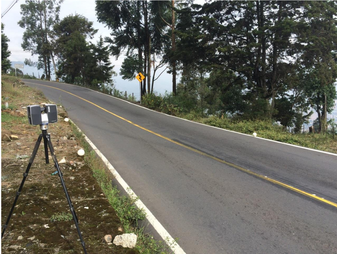
Figura 81. Escaneo de la vía que comunica al municipio de San Pedro, equipo LiDAR estacionario sobre trípode de apoyo, y ubicado sobre muro de gavión existente al costado norte de la vía. Fuente: Elaboración Propia.
