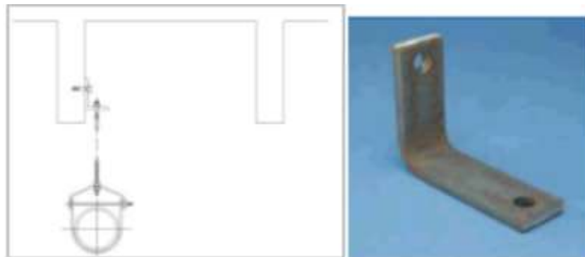
Imagen 18. Sujetador lateral para viga en concreto
