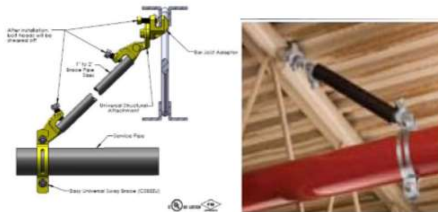
Imagen 25. Soporte longitudinal sismo resistente
