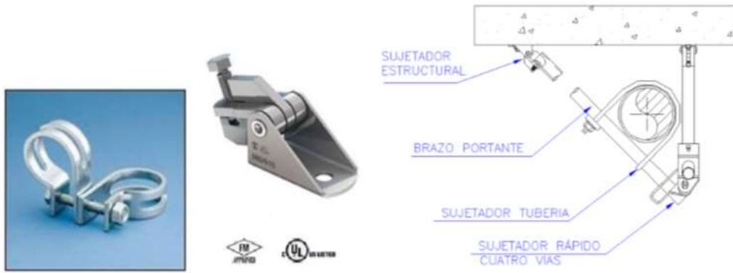
Imagen 30. Soporte lateral sismo resistente
