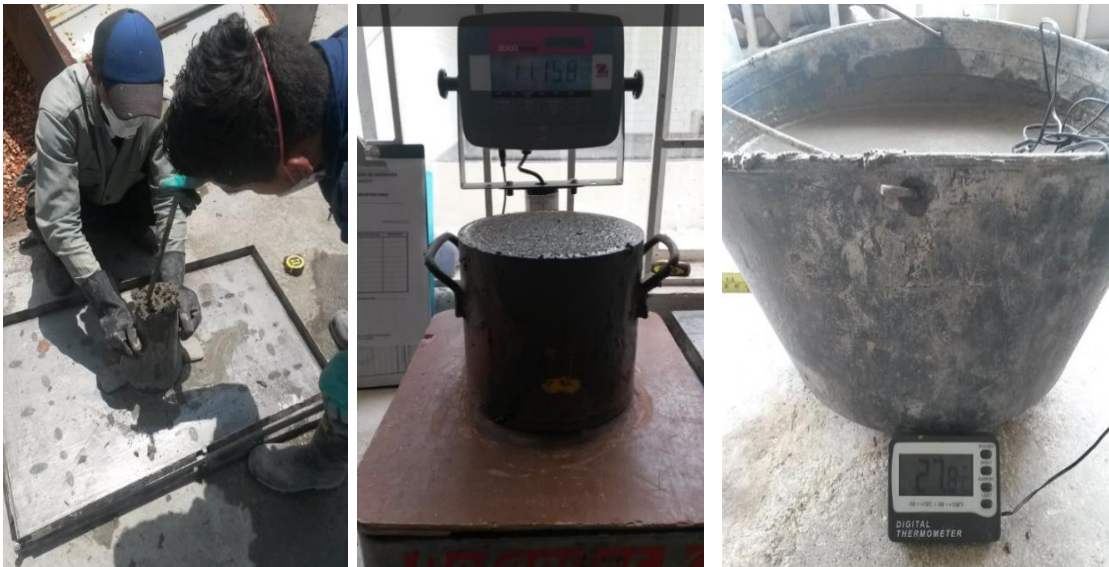
Figura 5 Ensayos en estado fresco de las mezclas
