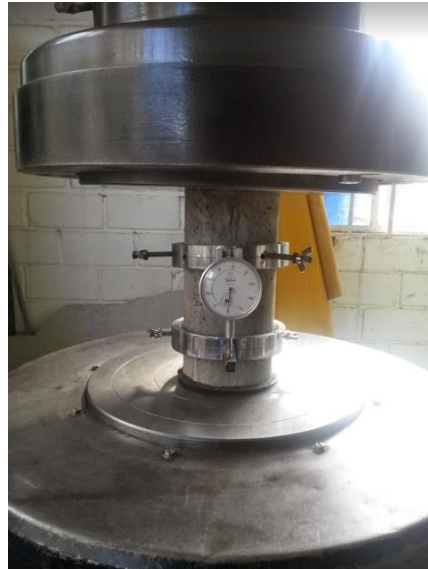
Figura 8 Montaje de cilindro con deformímetro para ensayo de módulo de elasticidad y resistencia a la compresión
