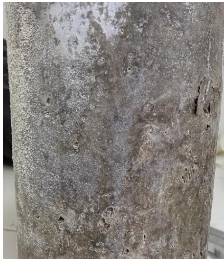
Figura 33 Afectación en la superficie del cilindro por sulfatos
