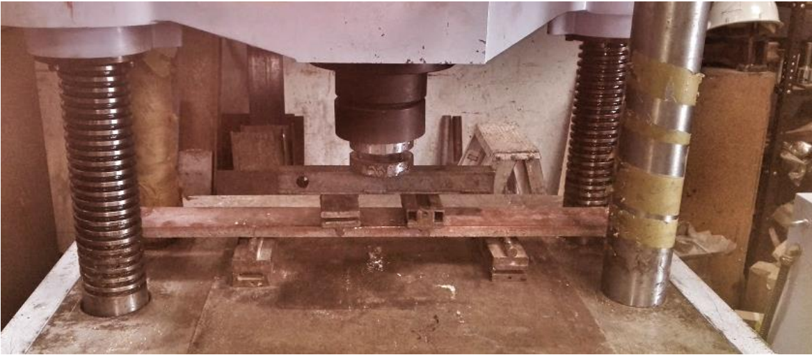
Figura 44 Montaje para ensayo a flexión de plaqueta tipo deck
