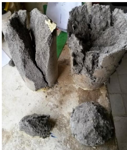
Figura 21 Cono de falla por compresión
