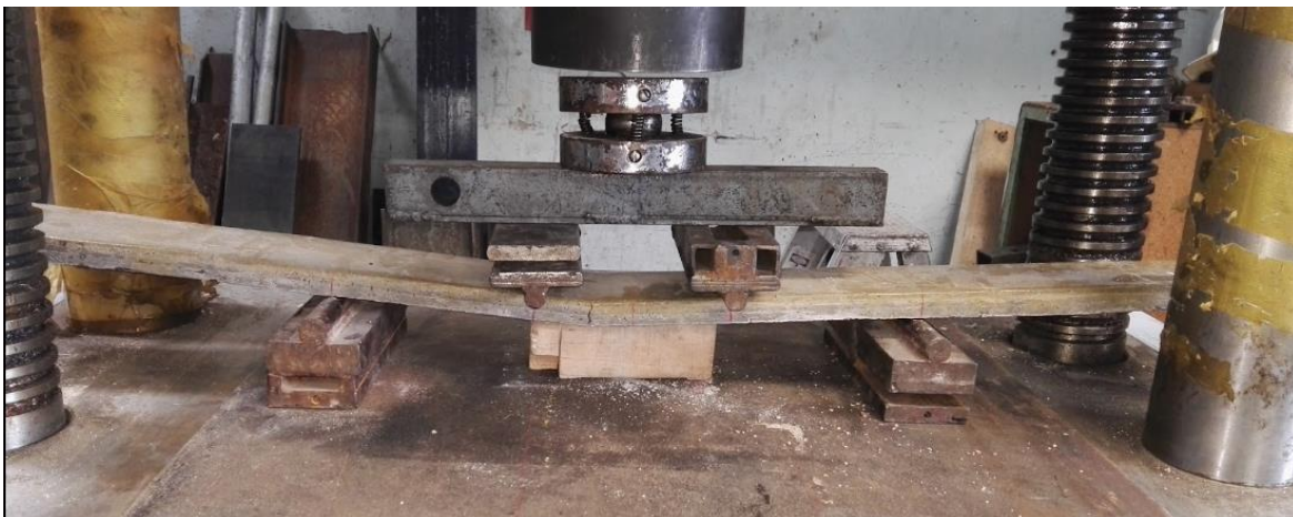
Figura 45 Momento de la falla plaqueta tipo deck en ensayo a flexión
