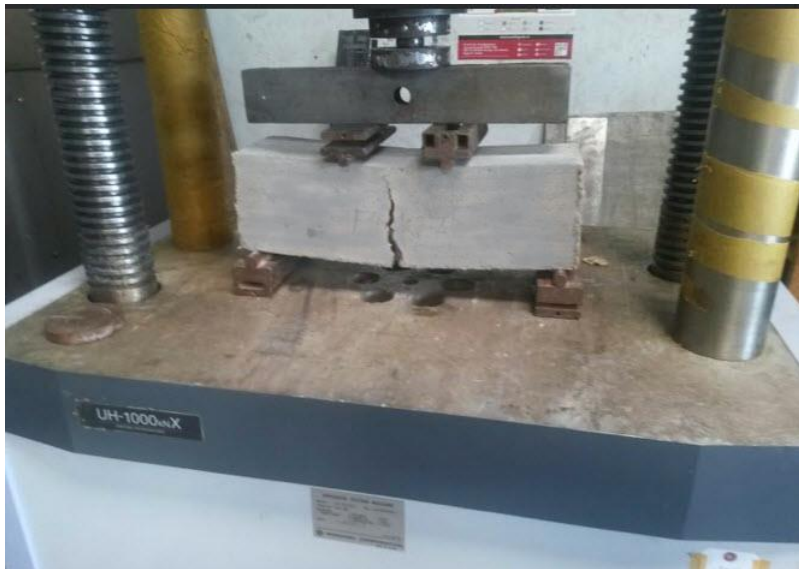
Figura 10 Ensayo de viga a flexión
