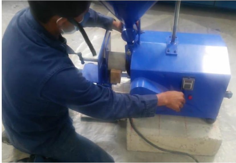
Figura 13 Montaje en equipo de ensayo abrasión chorro de arena y rueda metálica
