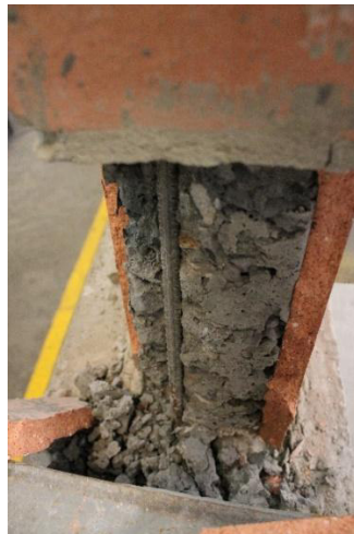
(a) Falla escalonada en la cara posterior del muro
