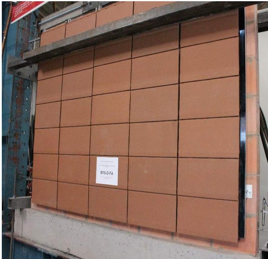
Fotografía 7-41 Montaje e instrumentación del muro M16-D-FA
