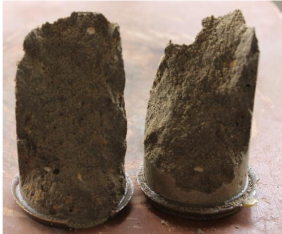
Fotografía 5-3 Falla de los cilindros de mortero durante el ensayo de compresión
