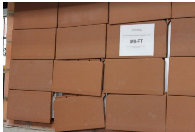
(e) Falla del anclaje del sistema de fachada al muro
