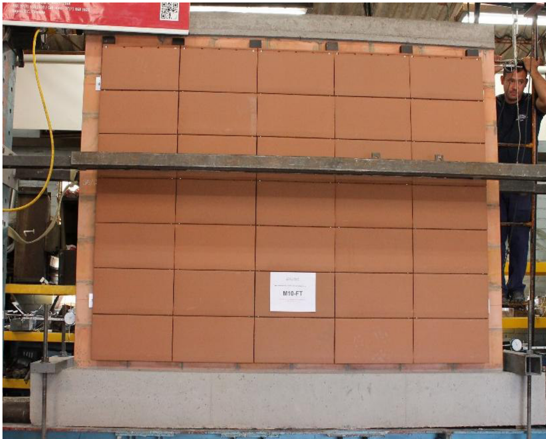
Fotografía 7-13 Montaje e instrumentación del muro M10-FT
