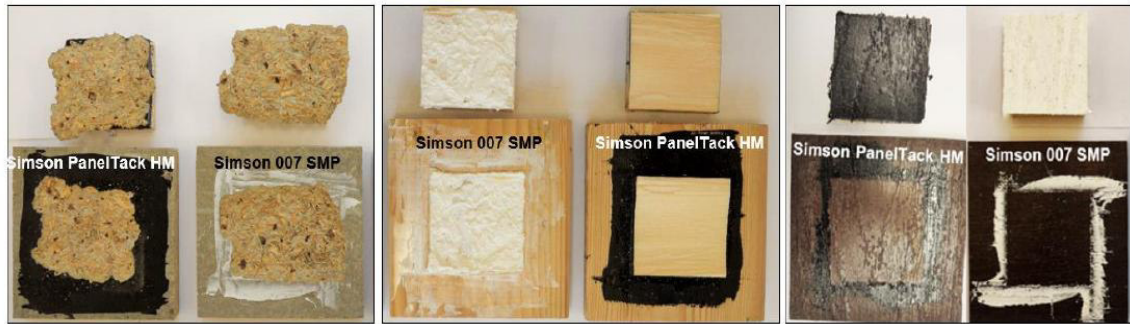
Fotografía 2-2 Falla de las muestras ensayadas, a) Aglomerado, b) Madera convencional, c) Madera plástica
