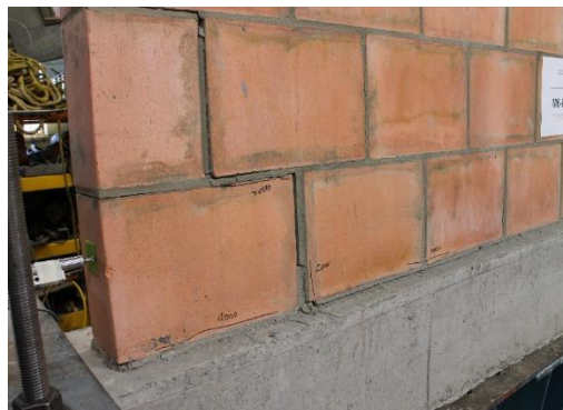
(a) Vista frontal falla escalonada en el muro
