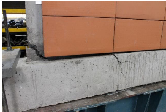
(a) Falla en la base del muro
