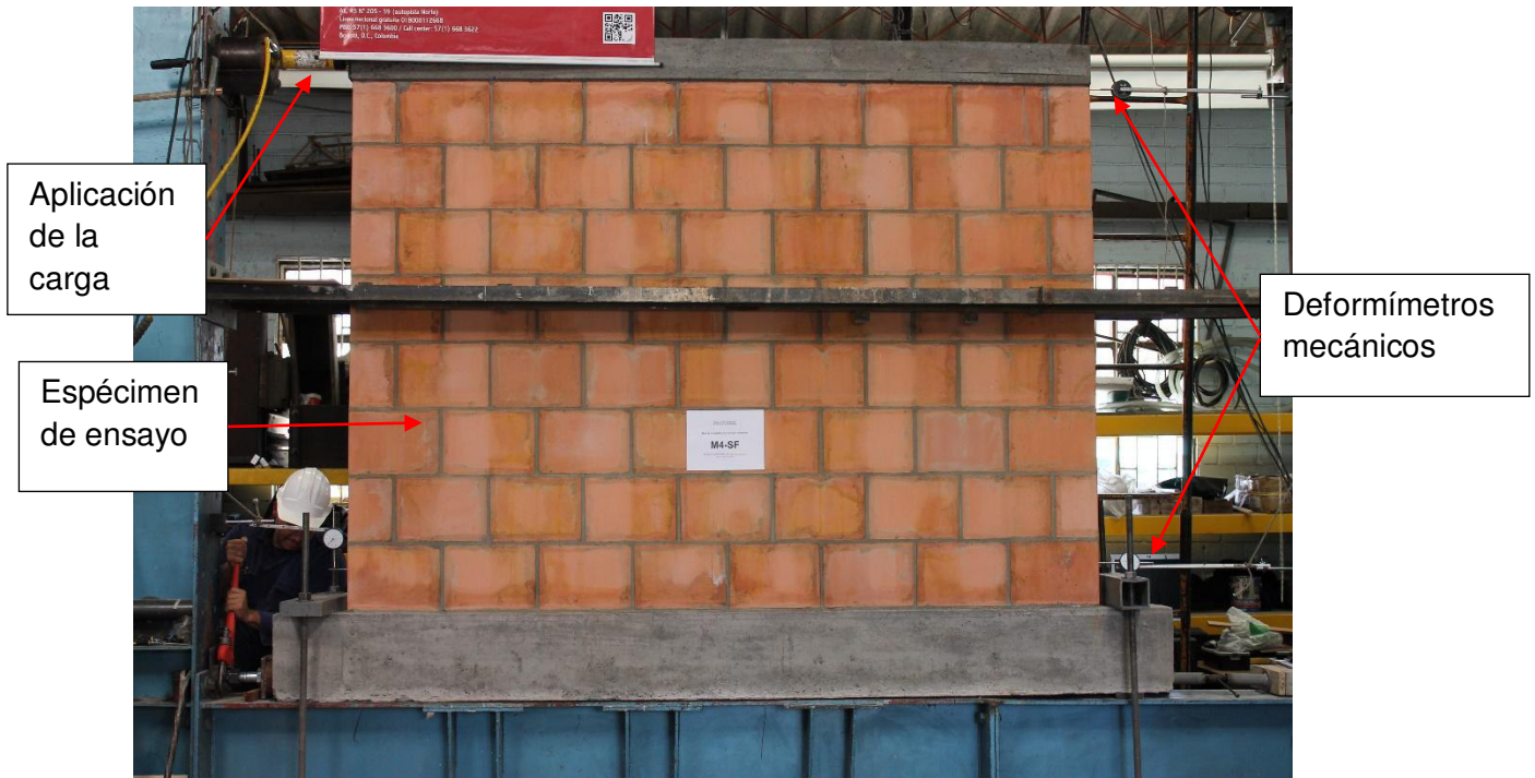
Fotografía 4-19 Montaje del ensayo monotónico
