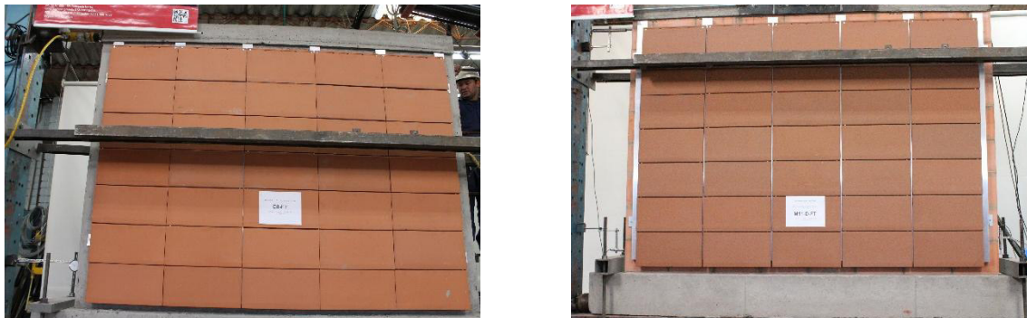
(f) Muros con fachada ventilada con tornillo
