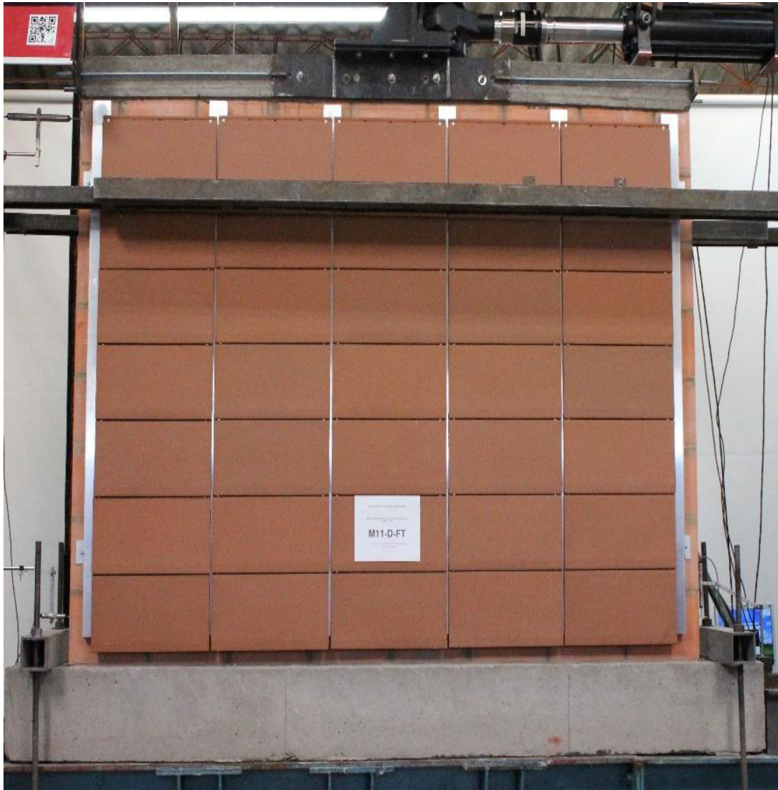
Fotografía 7-31 Montaje e instrumentación del muro M11-D-FT
