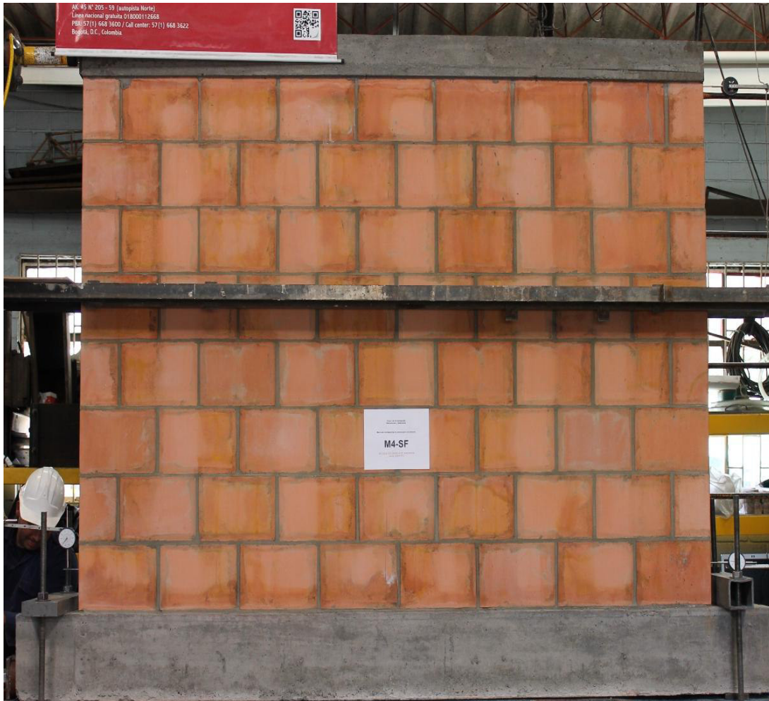
Fotografía 7-5 Montaje e instrumentación del muro M4-SF
