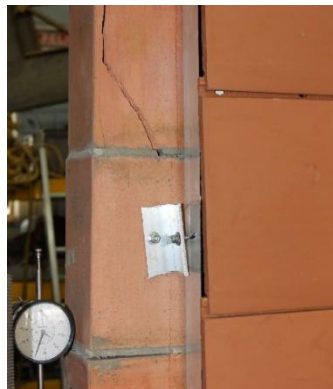
(d) Desplazamiento relativo de los elementos de fachada ventilada
