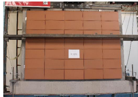
(h) Muros con fachada ventilada con adhesivo sikaflex 252
