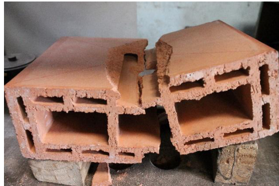
(d) Intento de formación del cono de extracción
