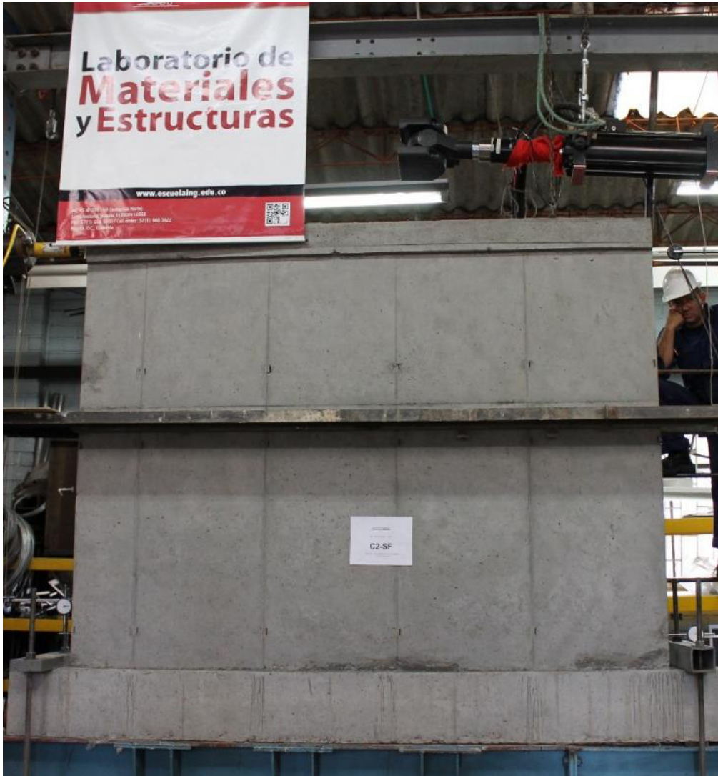
Fotografía 7-17 Montaje e instrumentación del muro C2-SF
