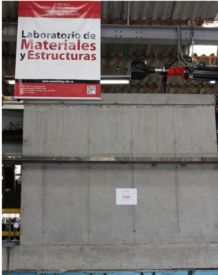
Fotografía 7-19 Montaje e instrumentación del muro C3-SF
