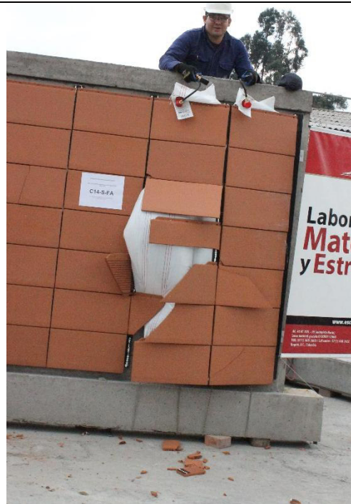
(a) Falla de la fachada adherida
