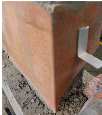
(a) Vista frontal de la falla escalonada en la zona del mortero
