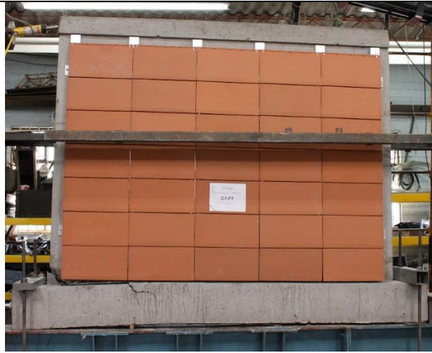
(a) Falla en la base del muro
