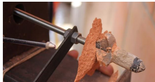
(d) Formación del cono de extracción
