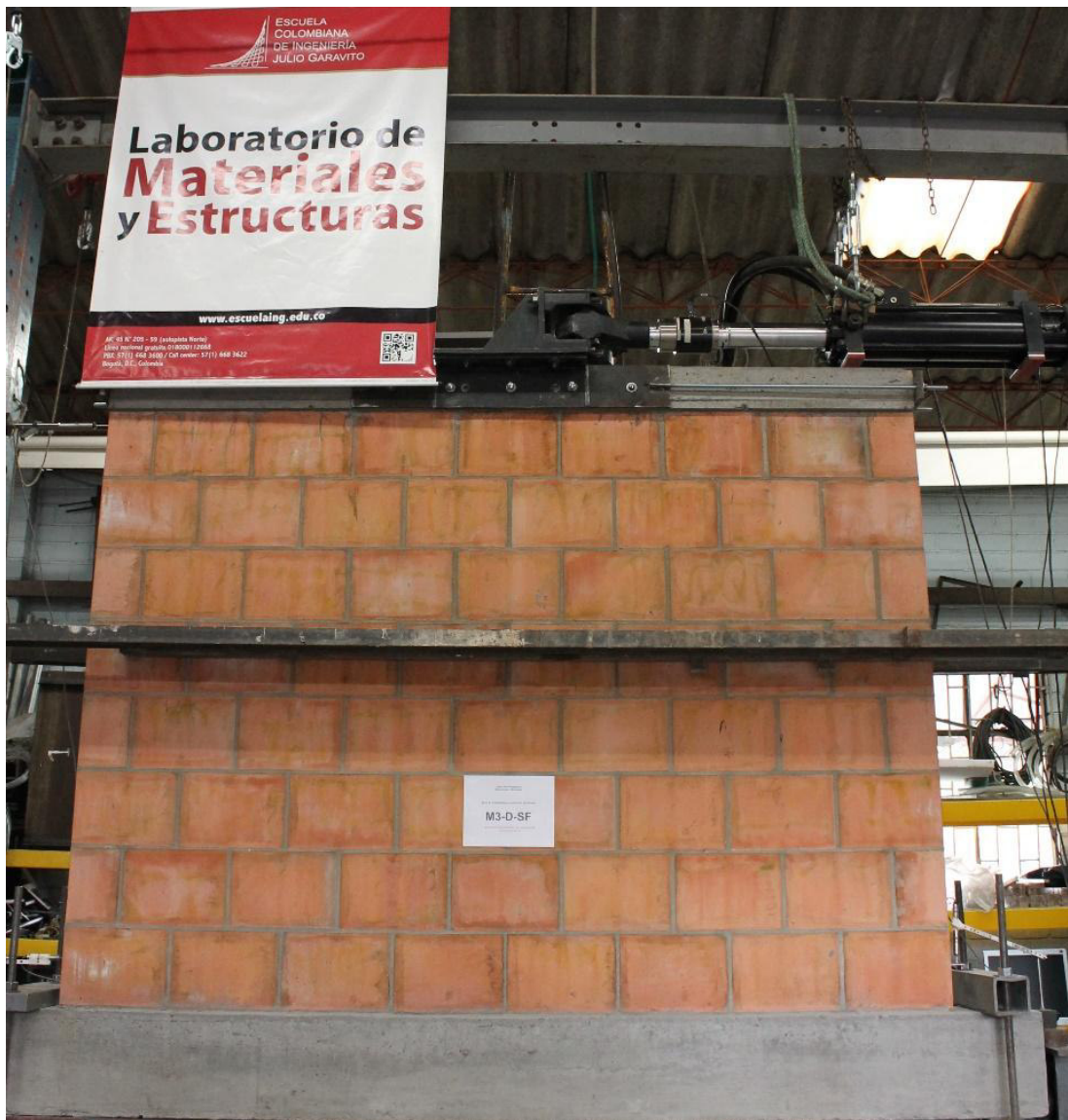
Fotografía 7-25 Montaje e instrumentación del muro M3-D-SF
