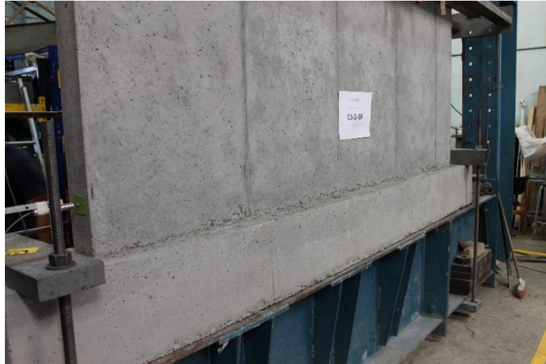
Fotografía 7-49 Montaje e instrumentación del muro C5-D-SF
