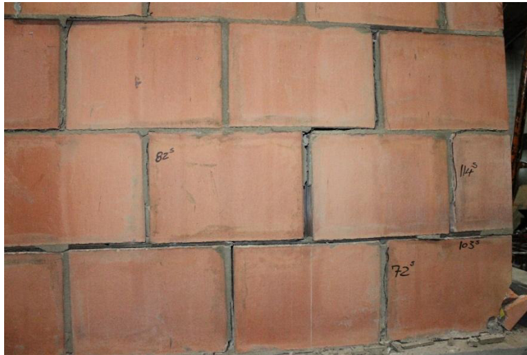
(a) Vista de la falla escalonada en la cara posterior del muro
