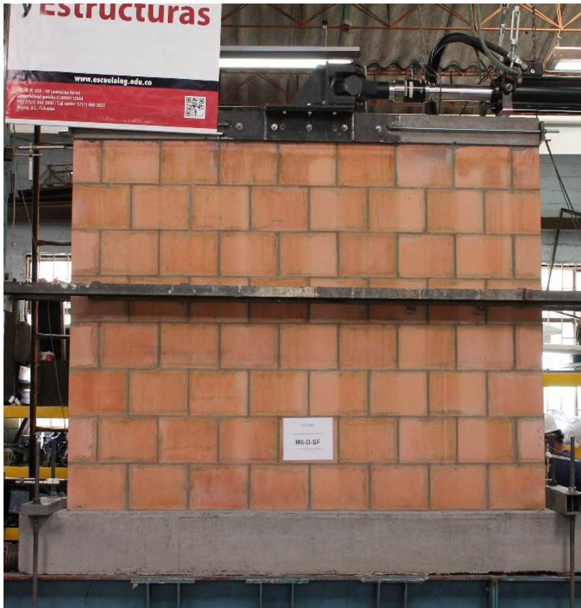
Fotografía 7-29 Montaje e instrumentación del muro M6-D-SF
