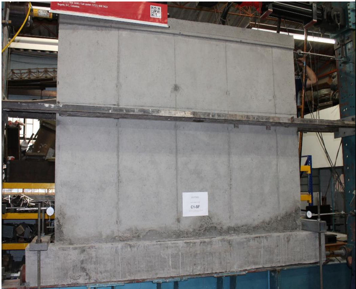
Fotografía 7-15 Montaje e instrumentación del muro C1-SF
