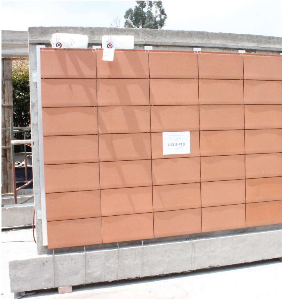
Fotografía 7-61 Montaje e instrumentación del muro C13-S-FTS
