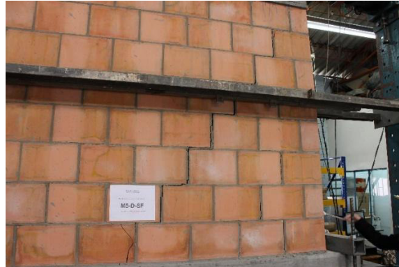
(a) Vista frontal de la falla escalonada en la zona del mortero
