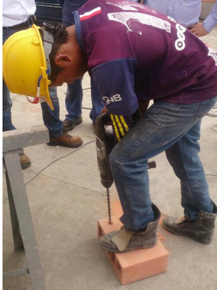
(a) Se perfora el bloque utilizando el taladro en la función de rotación
