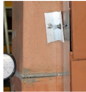
(d) Desplazamiento del perfil de soporte
