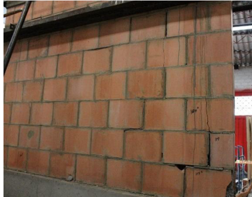
(a) Vista de la falla escalonada en la cara posterior del muro
