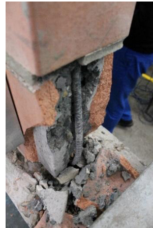
(b) Aplastamiento en las zonas de tensión y compresión
