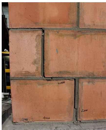
(a) Vista frontal falla escalonada en el muro
