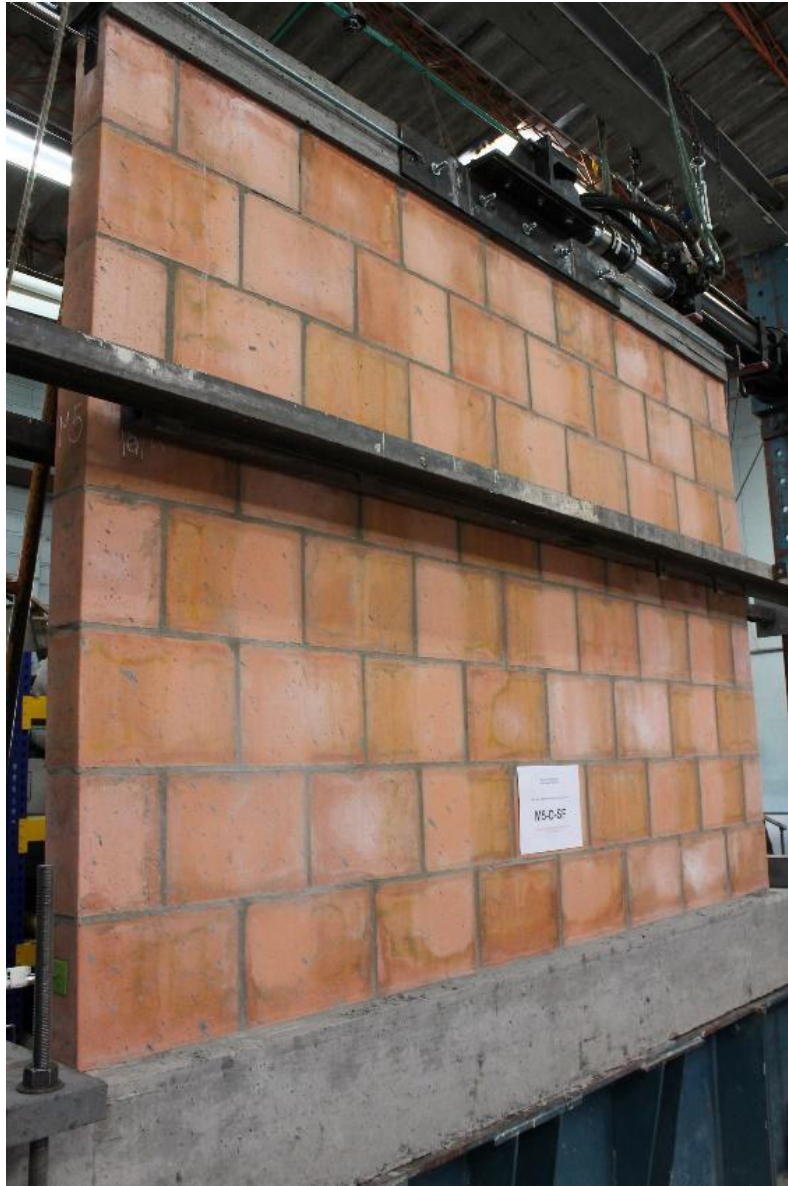
Fotografía 7-27 Montaje e instrumentación del muro M5-D-SF
