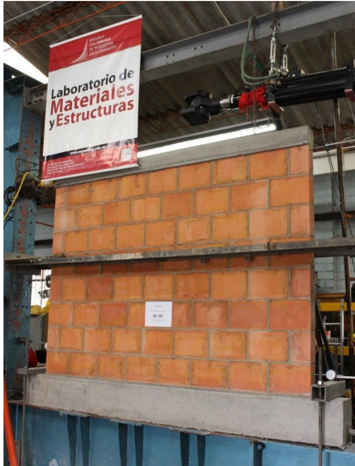
Fotografía 7-1 Montaje e instrumentación del muro M1-SF
