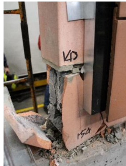
(a) Vista de la falla escalonada en la cara posterior del muro
