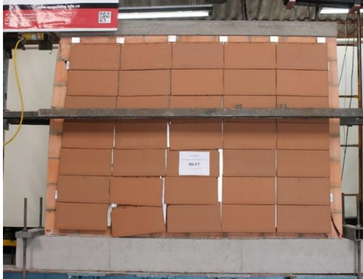
(a) Falla de la conexión de las piezas de arcilla de fachada al perfil
