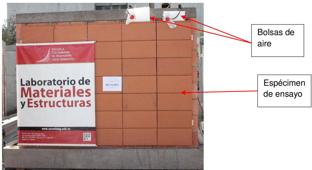
Fotografía 4-22 Montaje de ensayo de succión
