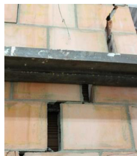
(b) Falla escalonada en la cara posterior del muro
