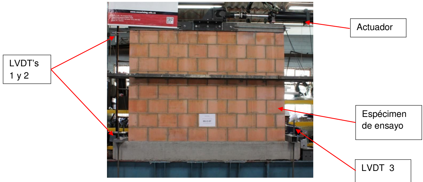
Fotografía 4-20 Montaje del ensayo pseudo-dinámico
