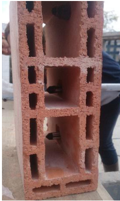
(e) Se aplica el epóxico químico dentro del tamiz
