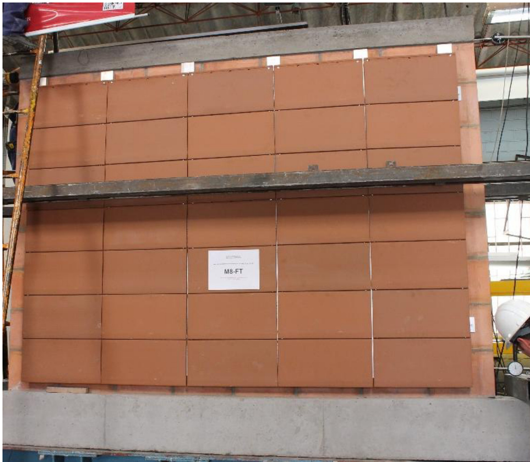
Fotografía 7-9 Montaje e instrumentación del muro M8-FT
