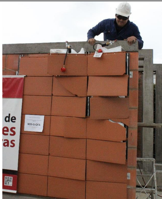
(a) Falla de los elementos de la fachada adherida
