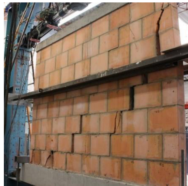
(b) Falla escalonada en la cara posterior del muro
