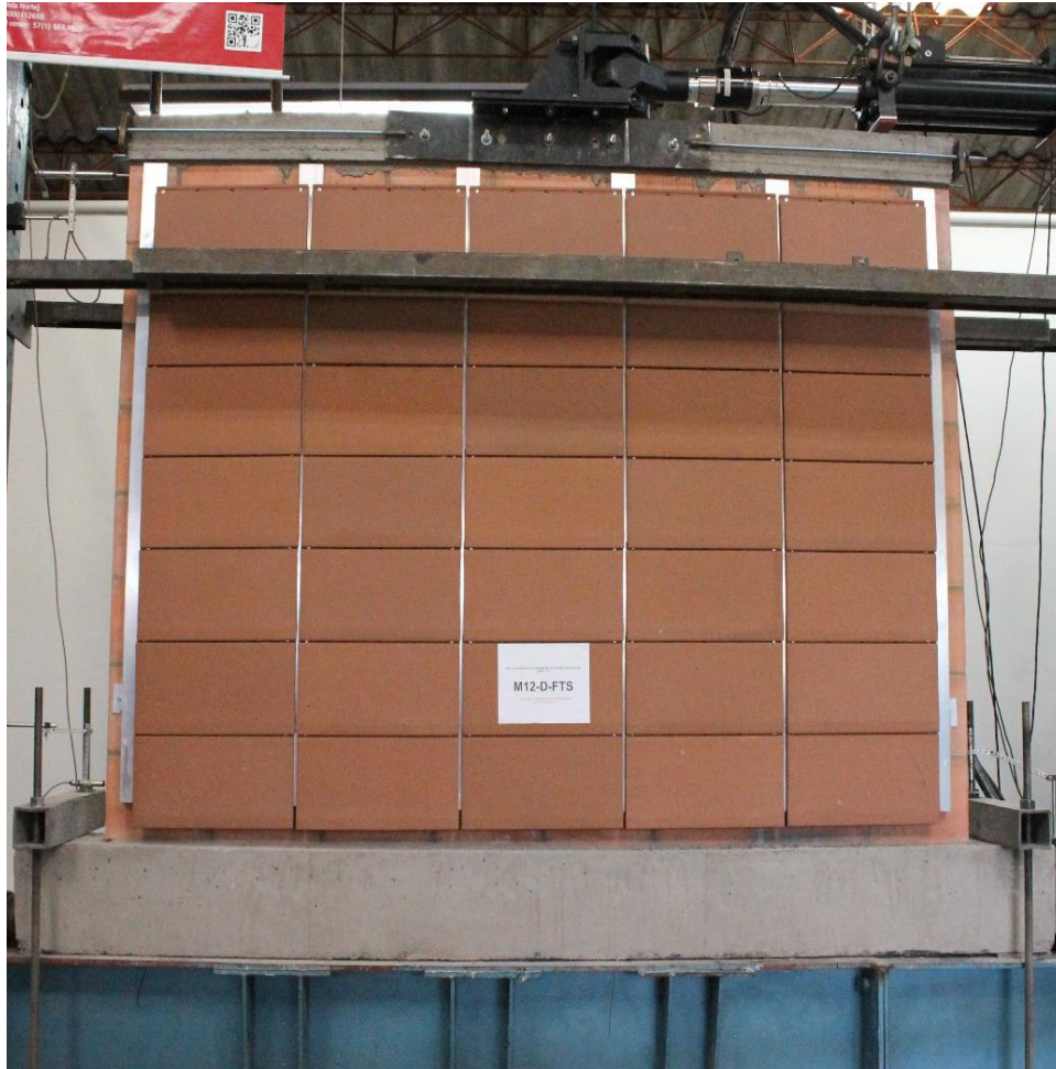
Fotografía 7-33 Montaje e instrumentación del muro M12-D-FTS
