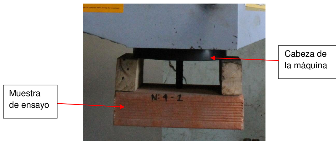
Fotografía 4-7 Montaje del ensayo de extracción de anclaje químico en unidades de mampostería.
