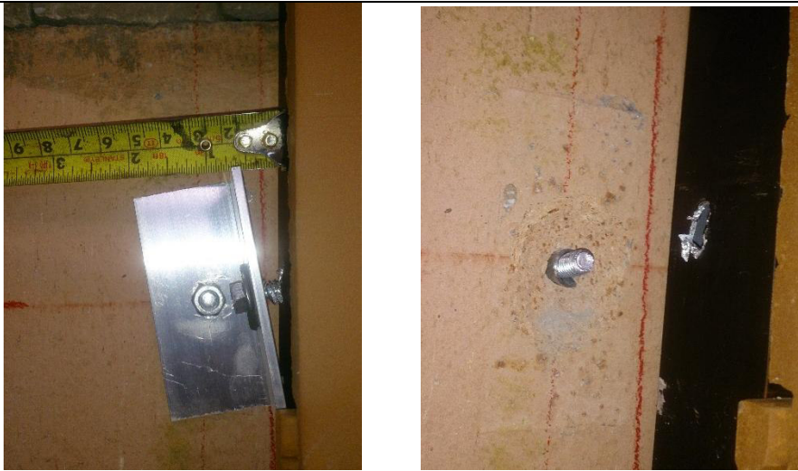
(c) Desplazamiento del perfil de soporte
