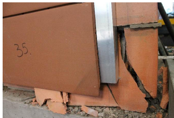
(a) Vista frontal de la falla del muro
