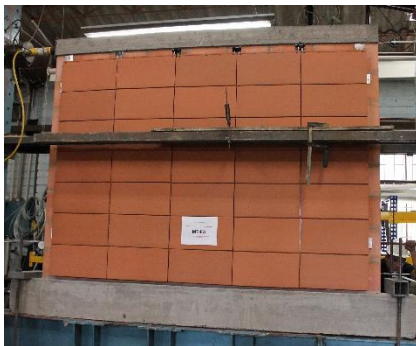
(h) Muros con fachada ventilada con adhesivo sikaflex 252
