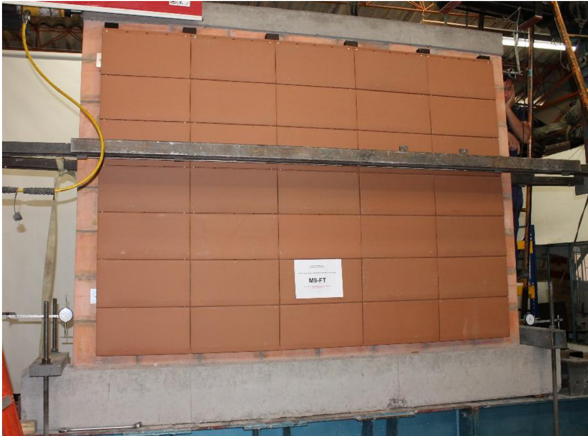
Fotografía 7-11 Montaje e instrumentación del muro M9-FT
