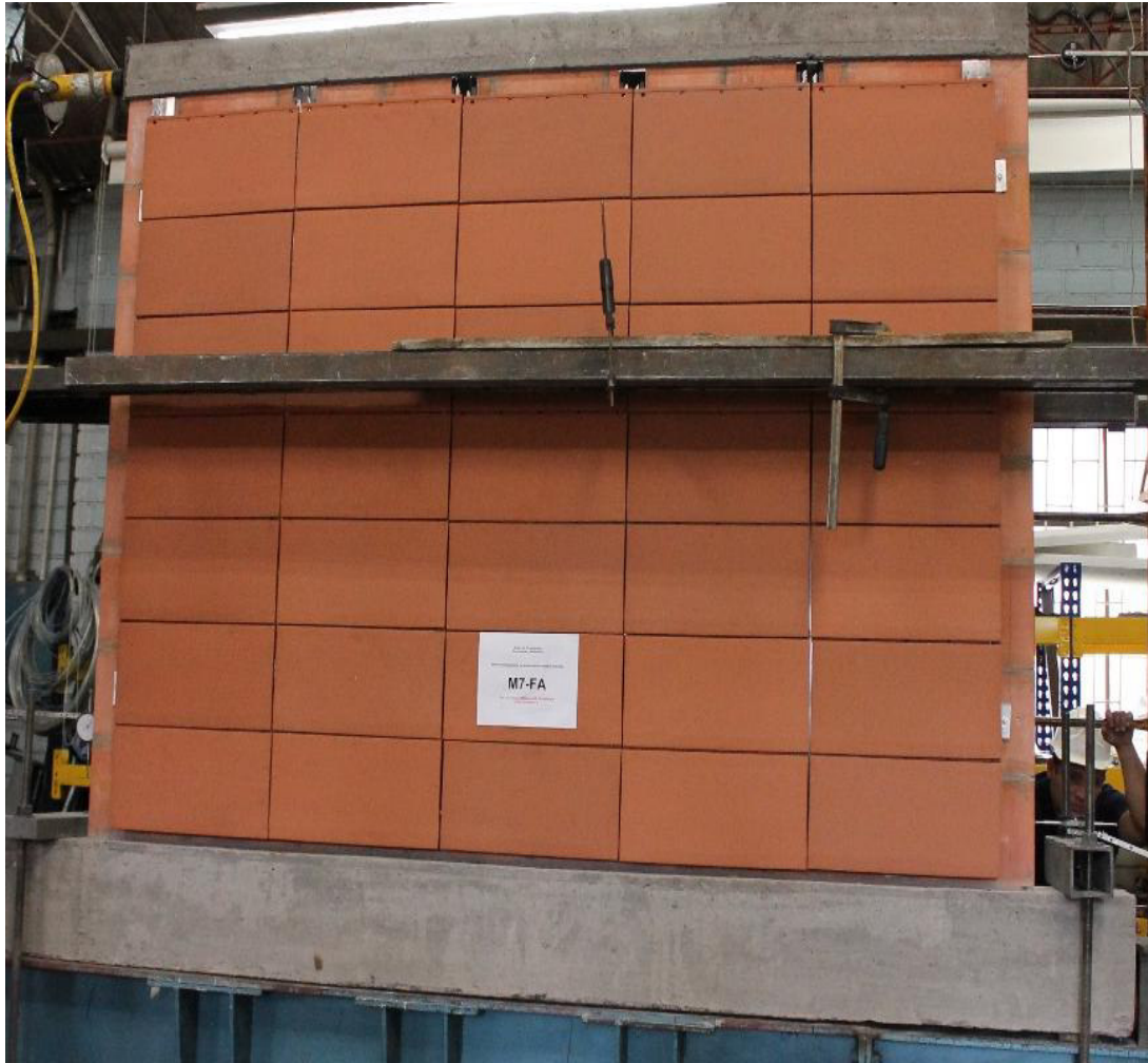
Fotografía 7-7 Montaje e instrumentación del muro M7-FA
