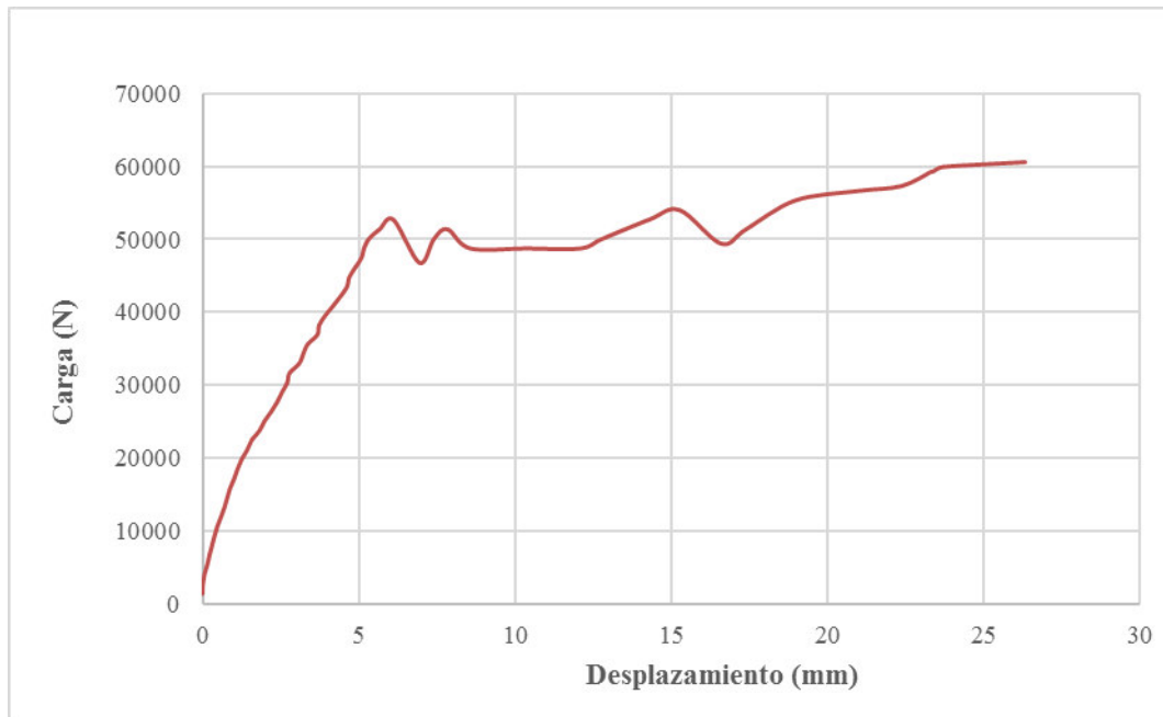
Gráfica 7-13 Carga lateral en el plano vs Desplazamiento muro M10-FT
