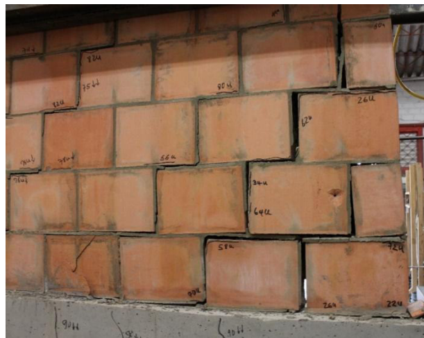
(b) Detalle de la falla escalonada
