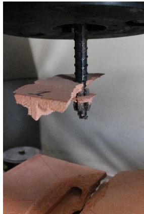
(c) Extracción anclaje en bloque LEPVD
