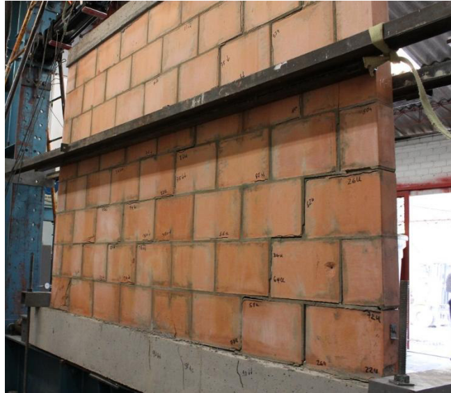
(a) Falla escalonada en la cara posterior del muro
