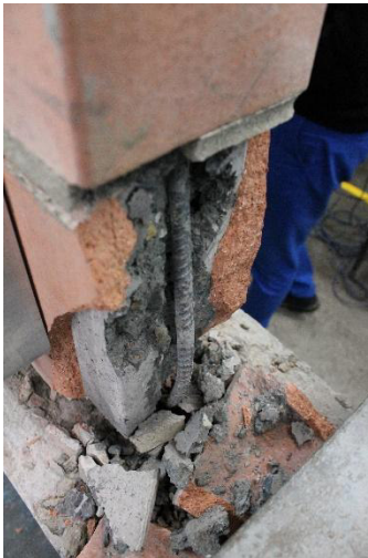
(a) Vista de la falla escalonada en la cara posterior del muro
