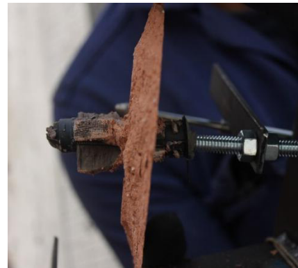
(d) Formación del cono de extracción
