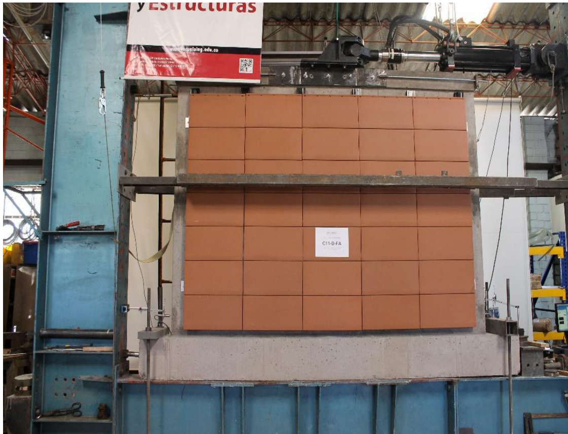
Fotografía 7-53 Montaje e instrumentación del muro C11-D-FA
