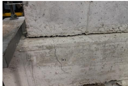
(b) Fisura en la parte superior del muro
