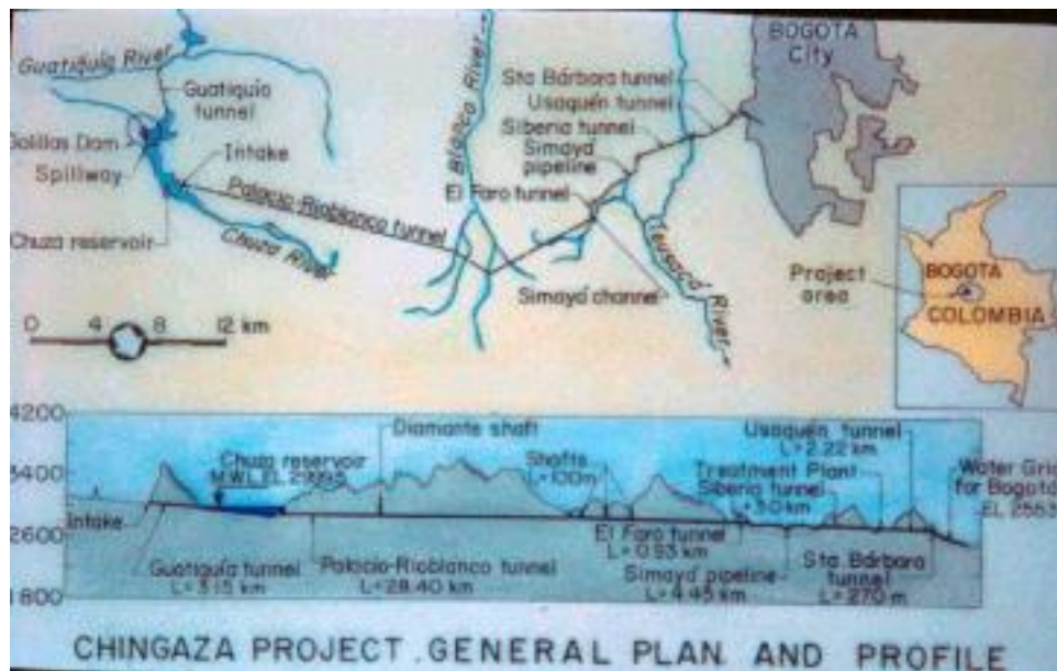
Figura 10-3. Localización en planta y perfil del túnel Palacio de Rioblanco (Chingaza). Fuente: (Marulanda E., 2008)
