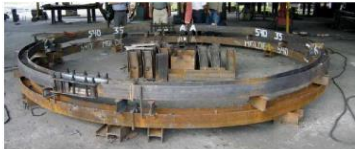
Figura 10-12. Anillos con diámetros ajustables con tolerancia a deformaciones viscoelásticas - Solución adoptada para el túnel. Fuente: (Grases, 2014)
