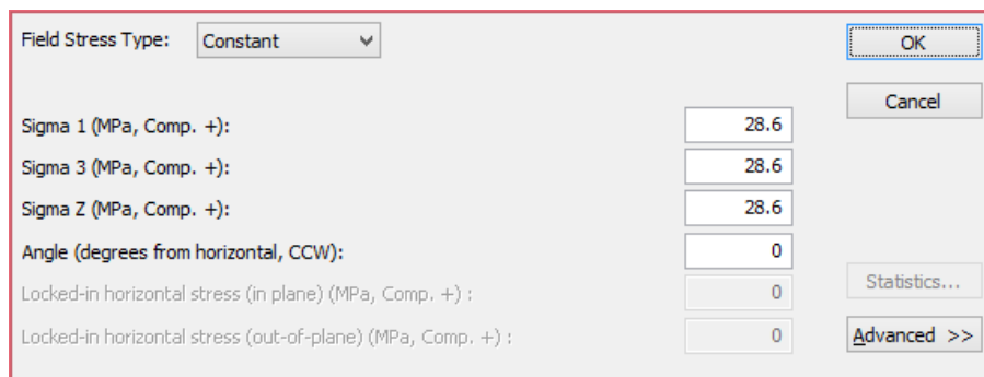
Figura 12-54. Campo de esfuerzos in-situ para el túnel Yacambú – Quibor – Zona 2. Fuente: Elaboración de la autora.
