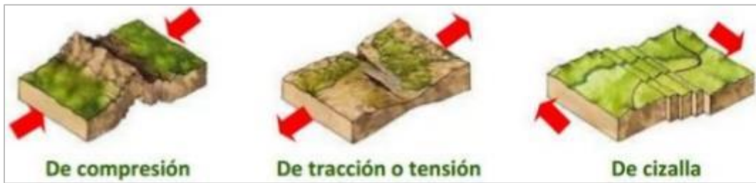
Figura 1-10. Tipos de esfuerzos que generan las deformaciones
