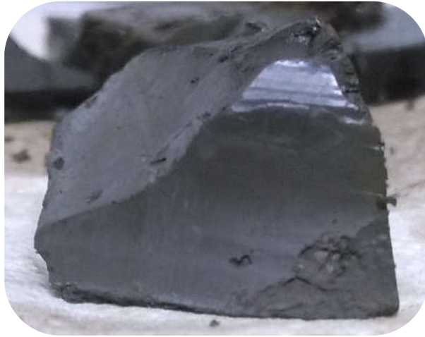
Figura 21. Corte longitudinal a la muestra C después de sumergirse en diésel 7 días. Fuente: Elaboración de la autora.
