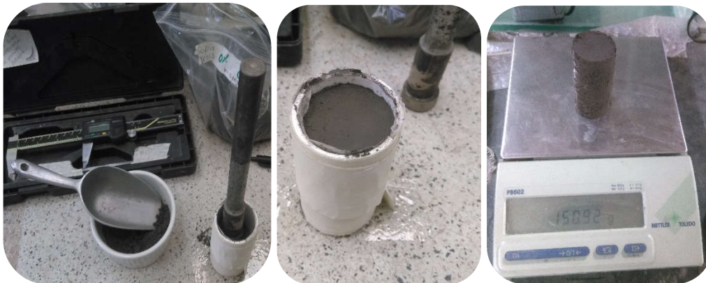
Figura 27. Compactación y elaboración de las probetas. Fuente: Elaboración de la autora.
