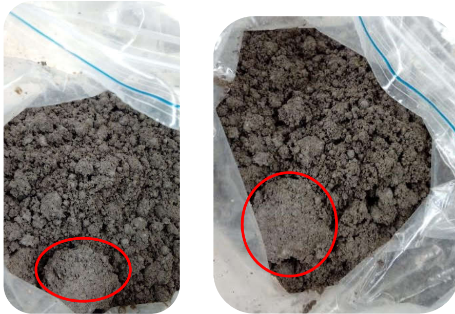
Figura 29. Muestras del suelo A con diésel y presencia de microorganismos. Fuente: Elaboración de la autora.
