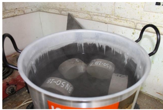
Fotografía 15. Izquierda - Probetas en inmersión por 48 horas. Derecha - Probetas hirviendo al finalizar el periodo de 5 horas.
