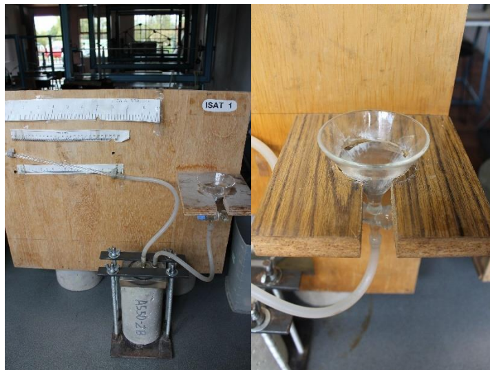
Ilustración 11. Esquema general del montaje del ensayo ISAT.
