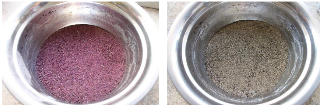
Fotografía6. Izquierda. Material sin carbonatar reaccionando a la fenolftaleína. Derecha - Material carbonatado sin reacción.
