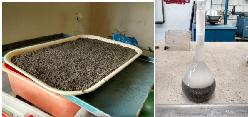
Fotografía9. Izquierda - Agregado en una condición SSS. Derecha – Bolón volumétrico usado en la prueba.
