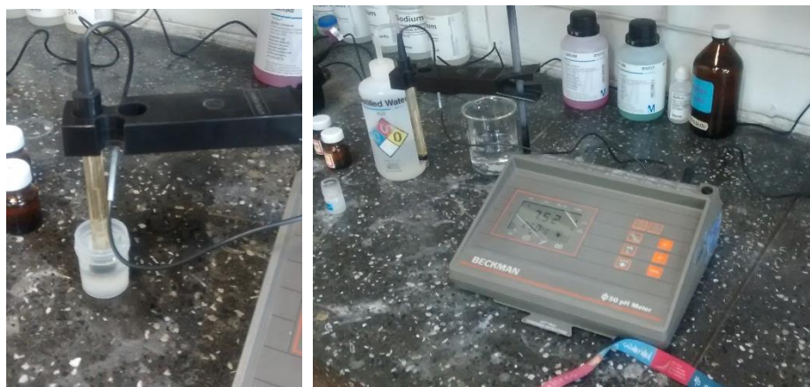
Fotografía18. Izquierda- Muestra de solución siendo procesada. Derecha - Aparato de medición de pH.
