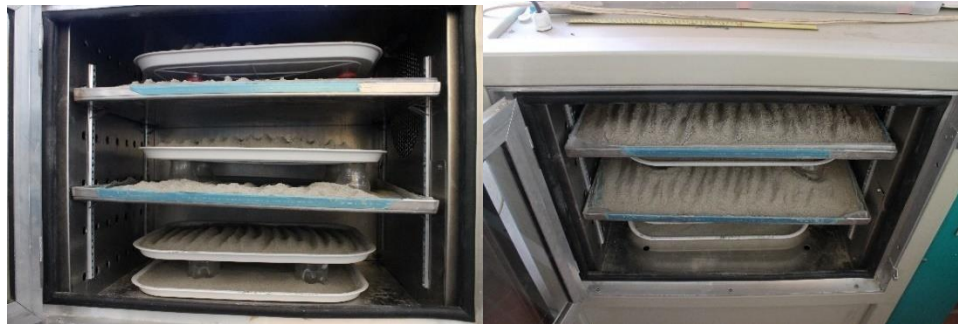
Fotografía4. Fotografías del agregado reciclado en cámara de carbonatación.
