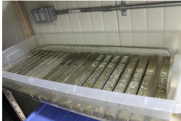
Fotografía17. Muestras de mortero en la solución de sulfatos.
