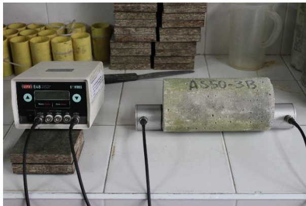
Fotografía 11. Montaje del ensayo de Velocidad de Pulso Ultrasónico (VPU).
