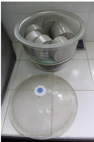
Fotografía14. Izquierda - Muestras en el desecador. Derecha - Muestra con recubrimiento epoxico.
