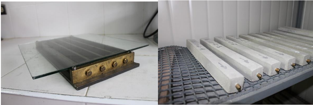
Fotografía16. Izquierda - Molde utilizado en la fabricación de las probetas. Derecha - Probetas en la cámara de humedad y temperatura controlada.
