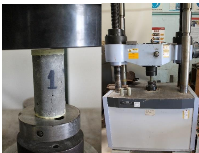
Fotografía 10. Izquierda - Detalle de la probeta en la máquina de ensayo. Derecha - Probeta en la maquina universal Shimadzu.
