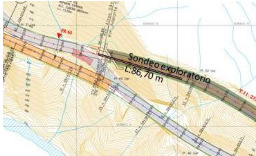
Figura 66 Localización de la perforación del portal entrada túnel 11 izquierdo (fuente consorcio ECC)
