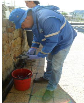
Lectura de pH y temperatura en el pozo.
