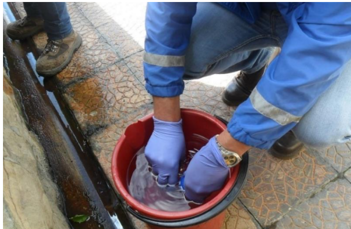
Fotografía 5.8. Toma con el vaso de muestra para el pozo profundo – Termalés 1. Fuente: Elaboración propia.
