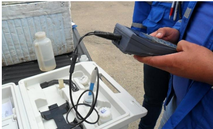
Fotografía 5.6. Calibración pHmetro 3110. Fuente: Elaboración propia.
