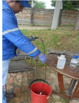
Lectura de pH y temperatura en el pozo.
