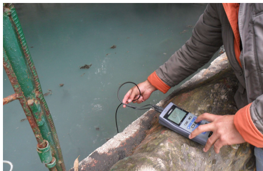
Lectura de pH y temperatura en el pozo.
