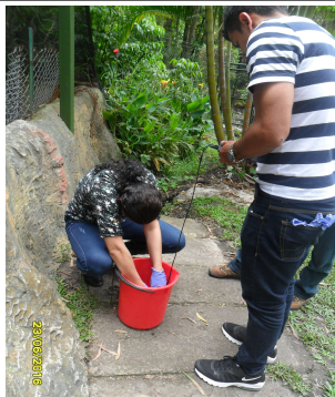
Toma de muestra y lectura de pH y temperatura en el pozo.
