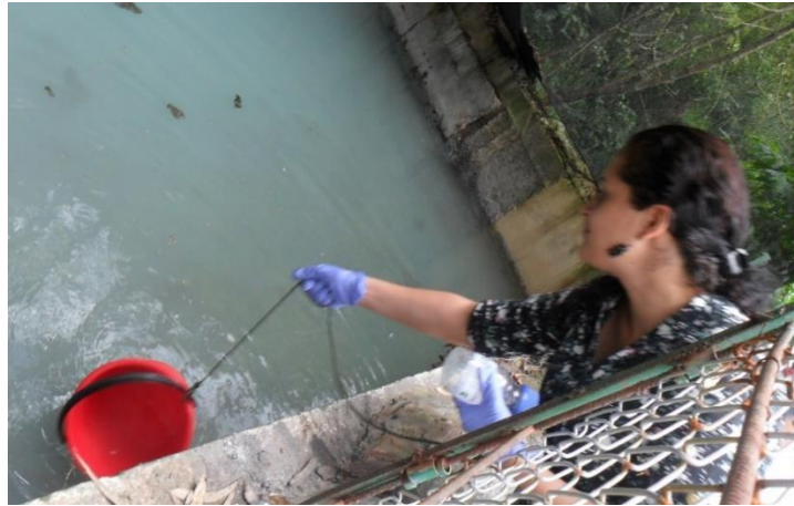
Fotografía 5.7. Toma de la muestra del pozo profundo con ayuda de un balde-Termalés 3. Fuente: Elaboración propia.
