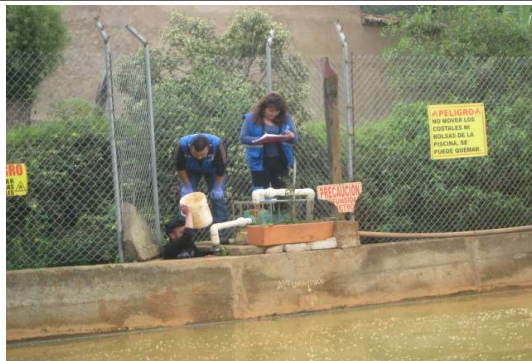
Toma de muestra en el pozo de abastecimiento con ayuda de un balde.
