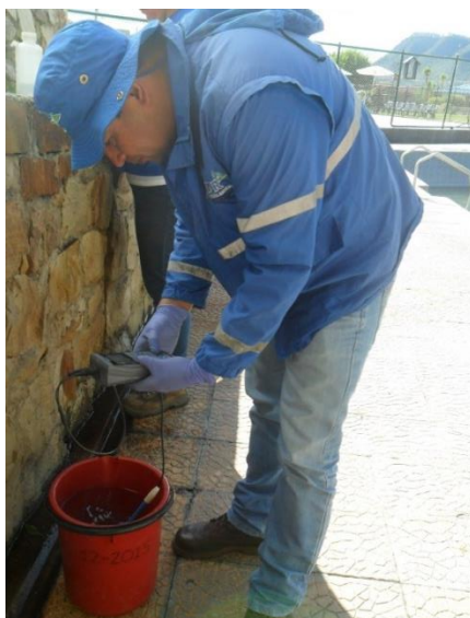
Fotografía 5.9. Lectura pH y temperatura en el pozo de abastecimiento – Termales 1. Fuente: Elaboración propia.
