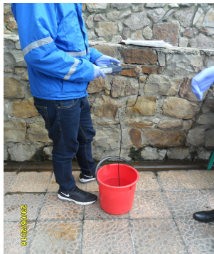
Lectura de pH y temperatura en el pozo.
