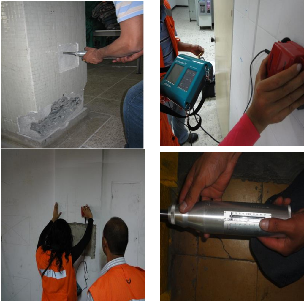
Ilustración 3-4: Prueba esclerómetro, ultrasonido, detector Refuerzo
