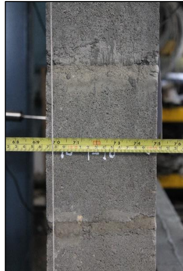
Foto 43 Línea de Plomada Antes de Desplazamientos
