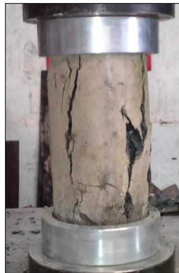
Foto 32 Detalle Falla Cilindros Mortero de Relleno 4
