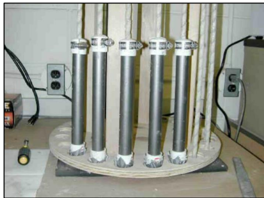
Foto 4 Detalle del Anclaje en el Extremo de las Barras
