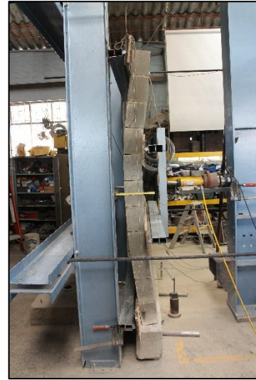
Foto 47 Deflexión del Muro
