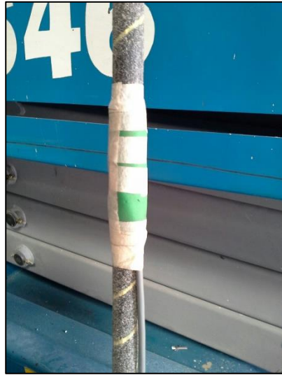
Foto 14 Protección Galgas en Barras
