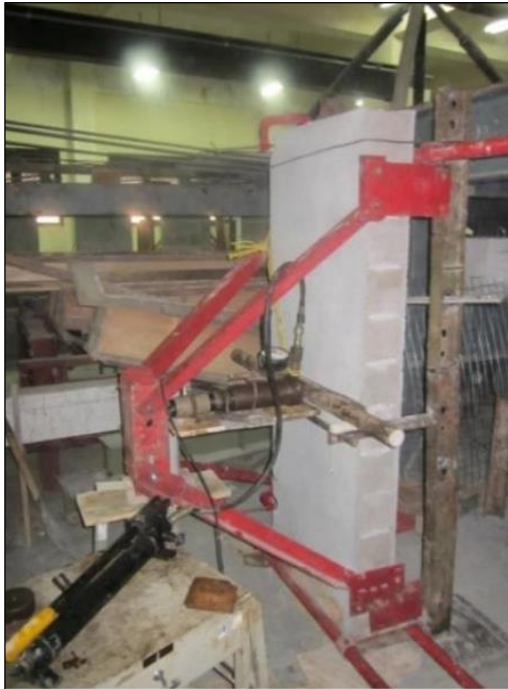
Foto 7 Montaje para Ensayo Muro con Refuerzo Vertical
