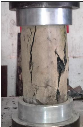
Foto 31 Detalle Falla Cilindros Mortero de Relleno 3
