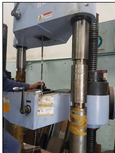
Foto 34 Ensayo Barras FRP
