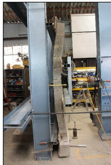
Foto 45 Deflexión del Muro
