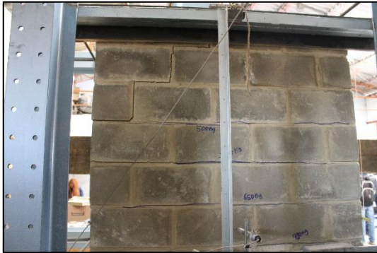
Foto 42 Fisuras Según Cargas
