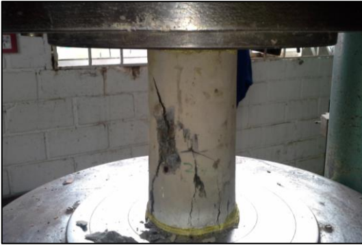
Foto 29 Detalle Falla Cilindros Mortero de Relleno 1
