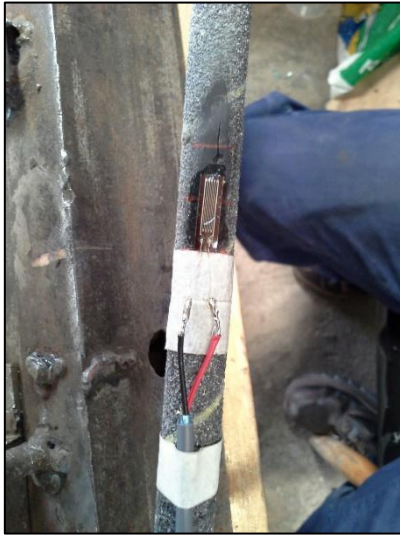
Foto 13 Instrumentación de Galgas en Barras
