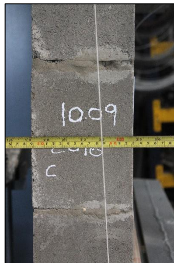
Foto 49 Línea de Plomada Después de Cargas
