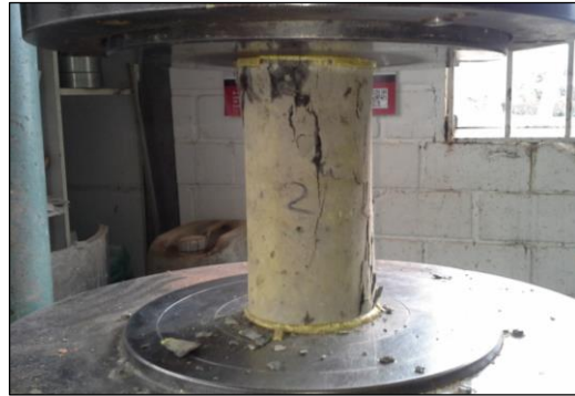
Foto 30 Detalle Falla Cilindros Mortero de Relleno 2
