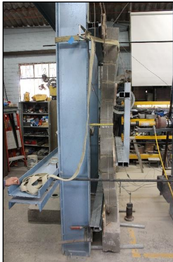
Foto 41 Deflexión del Muro
