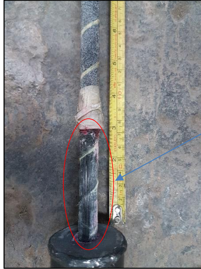
Foto 36 Detalle Falla a Tensión Barra GFRP
