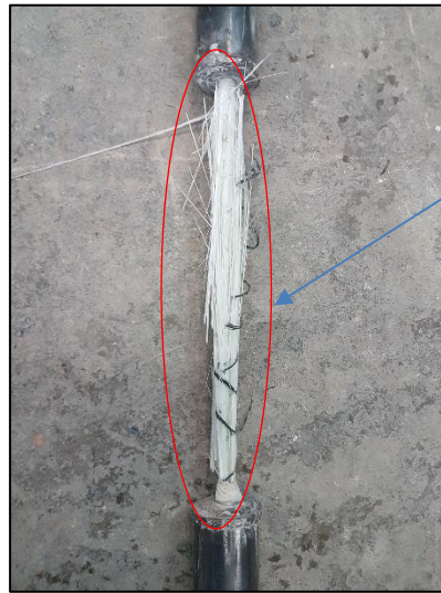
Foto 35 Detalle Falla a Tensión Barra GFRP
