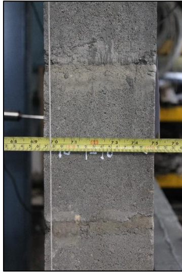
Foto 46 Línea de Plomada Antes de Desplazamientos
