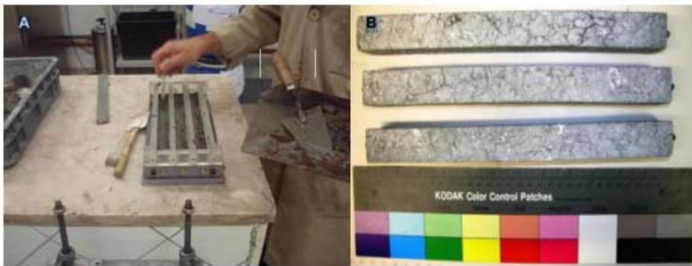
Figura 1-21 A) Preparación de barras de mortero. B) Aspecto final de las barras de mortero después de desmoldar. (Isabel & Ramos, 2013)
