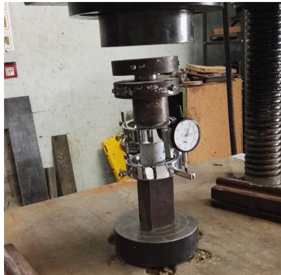
Figura 4-11 Montaje ensayo módulo de elasticidad.
