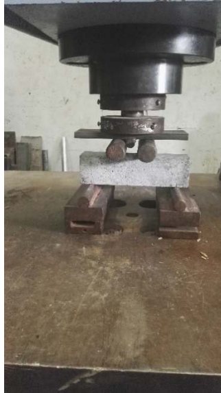
Figura 4-12 Montaje de ensayo de flexión de vigas.
