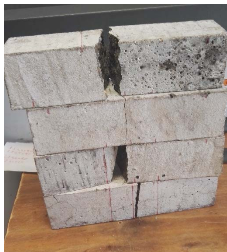
Figura 5-18 Aspecto de la falla en vigas de mortero.
