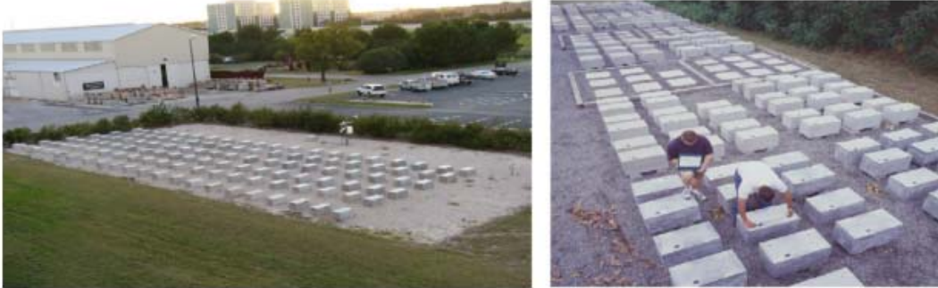
Figura 2-4 Campos de exposición de la universidad de Texas en Austin (Izquierda) y CANMET-TL en Ottawa (derecha).
