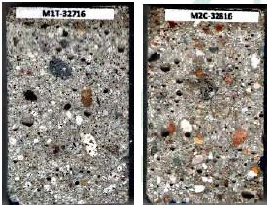
Figura 5-22 Secciones delgadas de las muestras. Informe NRBMICROMATCO S.A.S
